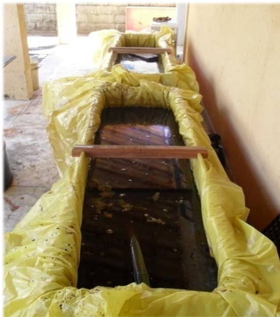
Figura 5. Colmos submetidos ao tratamento de imersão prolongada.
