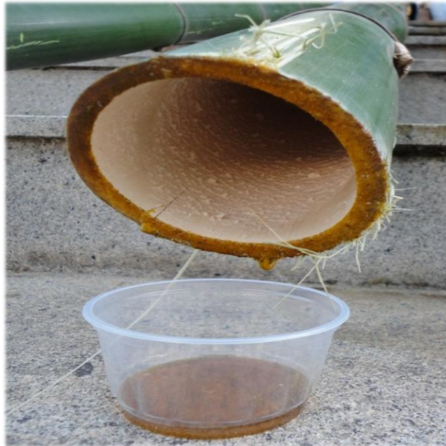
Figura 6. Colmos de bambu submetidos ao tratamento de Boucherie modificado.
