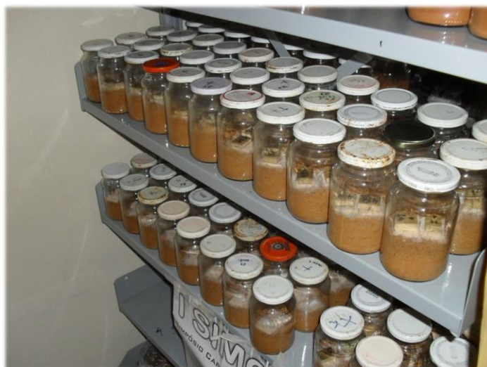
Figura 10. Ensaio acelerado de apodrecimento com fungos.
