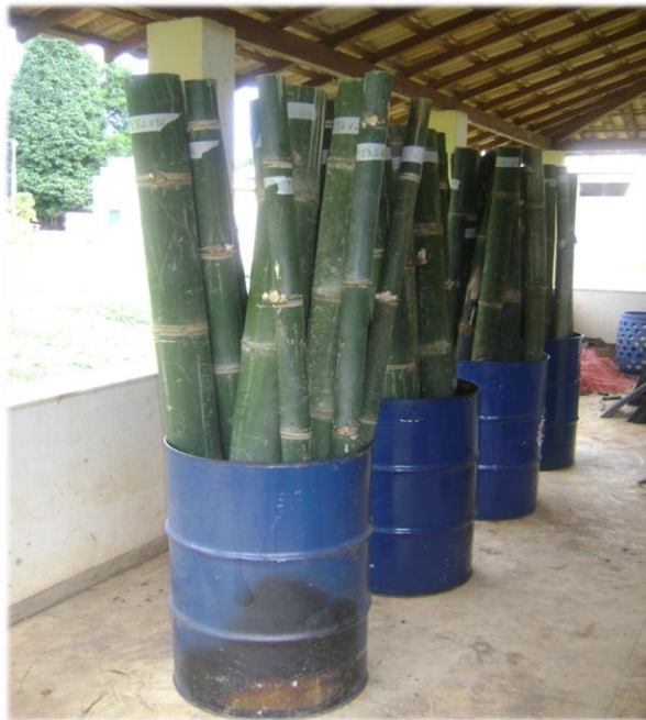
Figura 3. Disposição dos colmos nos tambores para o tratamento de transpiração.
