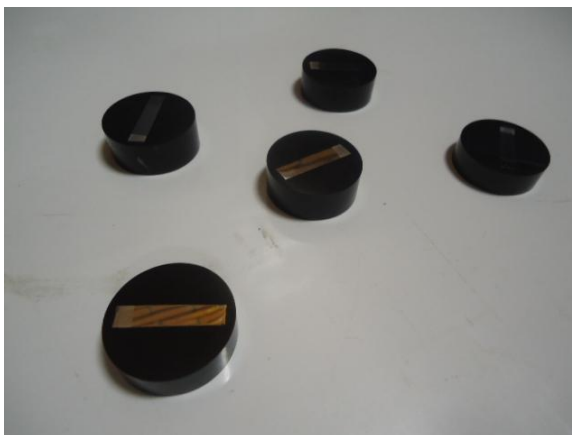
Figura 3. 7 - Amostras embutidas para medição de microdureza na região central da cratera de desgaste. As amostras embutidas possuem diâmetro de 25 mm.
