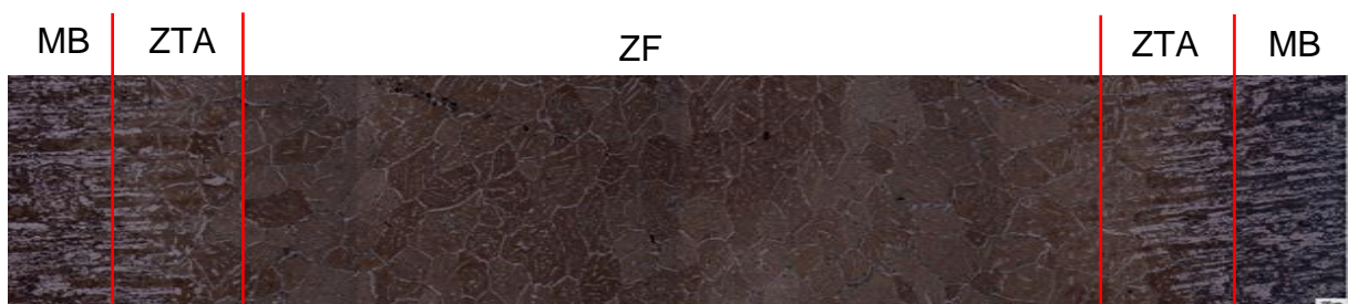
Figura 4.10- Perfil da amostra D2 mostrando MB, ZTA e ZF atacado com reagente Behara
