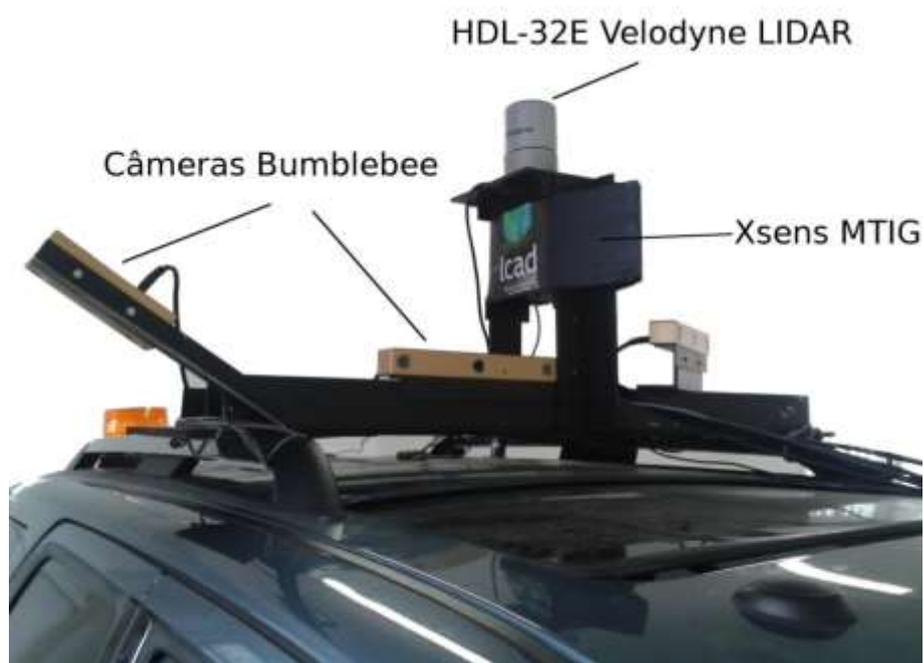
**Figura 22 - Sensores utilizados**
