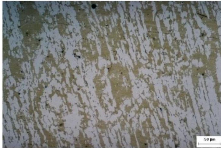
Figura 24 - Microestrutura do aço UNS S32304 tratado a 750°C durante 8 horas (amostra B). Ataque de Groesbeck [61].
