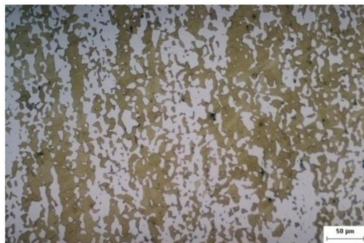
Figura 24 - Microestrutura do aço UNS S32304 tratado a 750°C durante 8 horas (amostra B). Ataque de Groesbeck [61].
