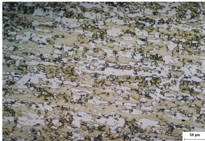
Figura 22 - Microestrutura do aço UNS S32304 no estado como recebido (amostra CR). Ataque de Groesbeck [61].
