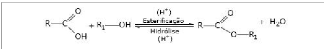
Figura 2: Reação de esterificação (Solomos & Fryhle, 2002).
