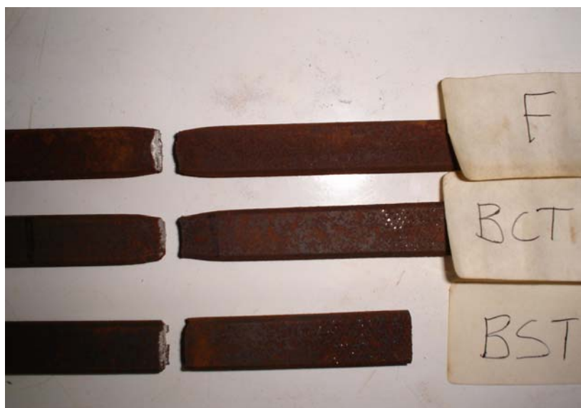
Figura 3.13 – Amostras dos 3 materiais após exposição ao meio de teste.
