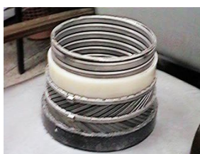
Figura 1.16 – Tubo flexível de arranjo básico.
