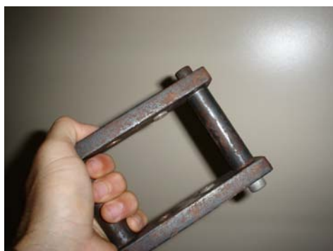
Figura 2.13 – Suporte usado nos ensaios de deformação constante.
