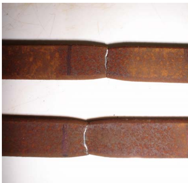
Figura 3.8 - Amostras do material F expostas ao meio de teste.
