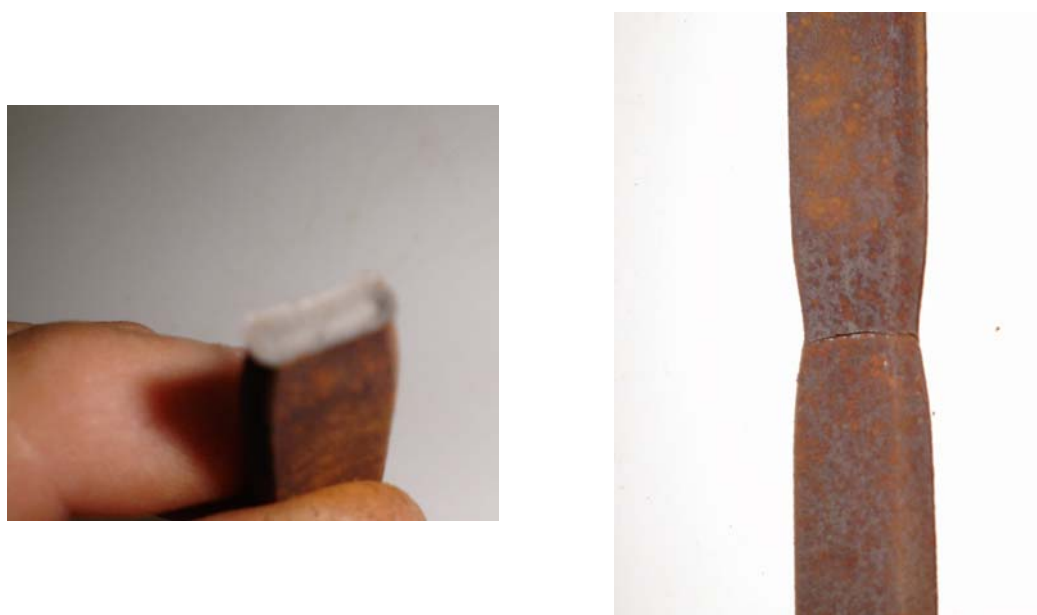
Figura 3.12 – Amostra do material BCT exposta ao meio de teste.
