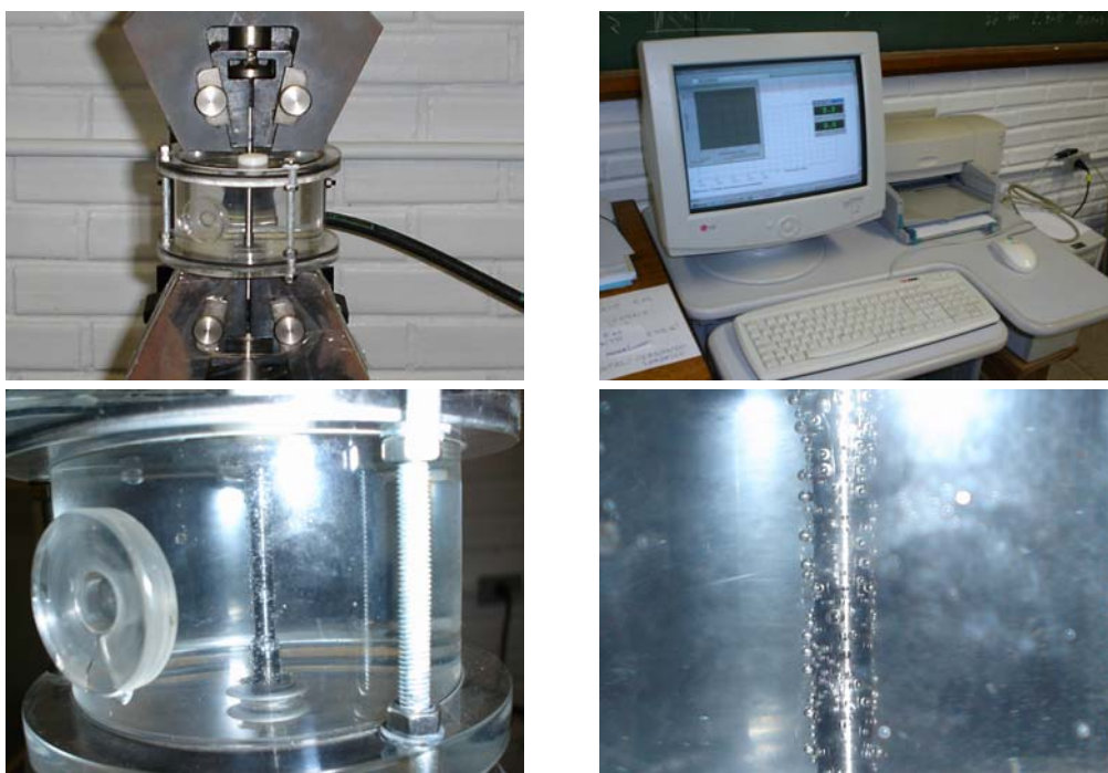
Figura 2.9 – Ensaio de CST em baixa taxa de deformação.
