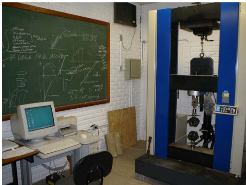
Figura 2.6 – Máquina de tração utilizada nos ensaios de baixa taxa de deformação.
