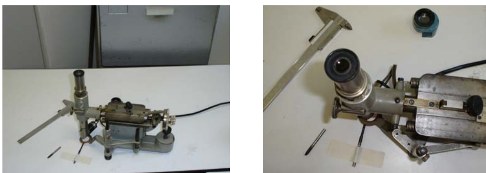
Figura 2.10 – Medidor óptico usado na medição da redução de área dos CPs.
