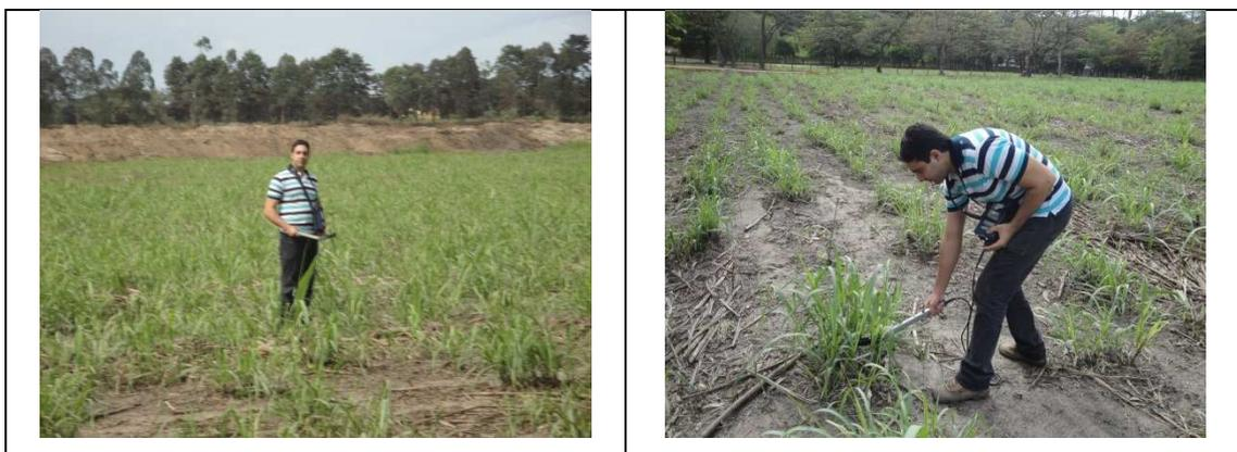
Figura 9. Fotografia ilustrativa mostrando a técnica utilizada na coleta do índice de Área Foliar por meio do espectrorradiômetro LAI-2000.
