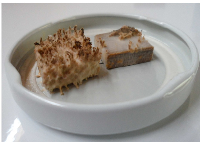
Figura 6. Corpos de prova submetidos ao ataque do fungo Gloeophyllum trabeum .
