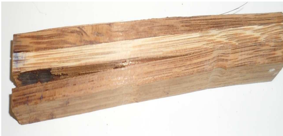
Figura 19. Rompimento parcial do corpo de prova na linha de cola.
