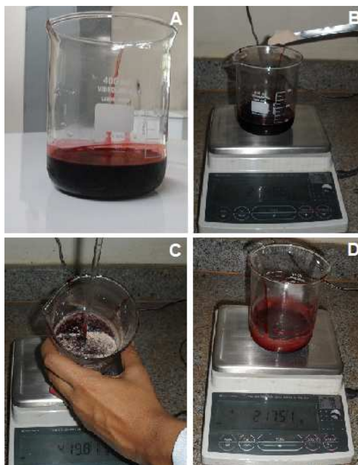
Figura 8. Etapas do preparo do adesivo à base de RF; A) béquer contendo RF; B) adição do catalizador; C) homogeneização; D) mistura final.
