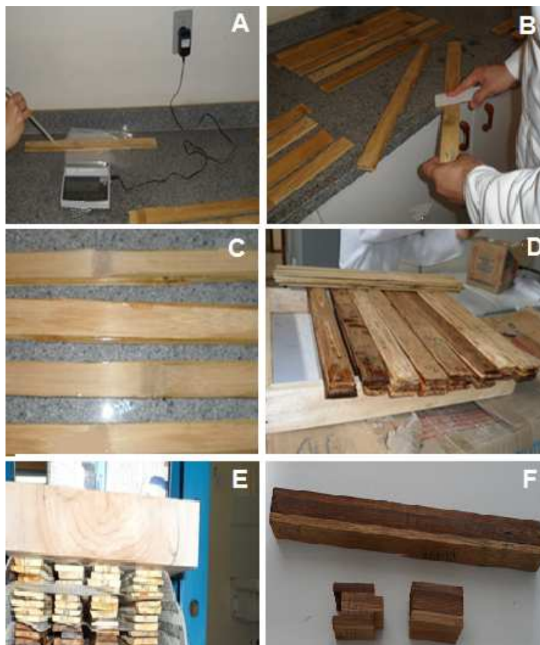
Figura 11. Etapas para o preparo dos corpos de prova: A) Aplicação do adesivo na superfície das taliscas; B) Distribuição do adesivo na superfície da talisca com uma espátula; C) união das taliscas; D) confecção do BLCTR; E) Prensagem dos conjuntos de BLCTR; e F) Corpos de prova.
