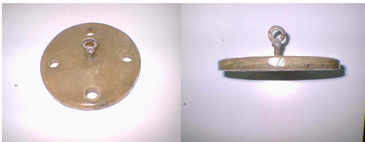
Figura 28 - Fotografias da tampa de fixação do fio de nylon para aprisionamento dos cupons
