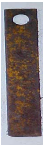
Figura 32 – Fotografia de um cupom de prova exposto ao condensado de COG por um período de seis meses
