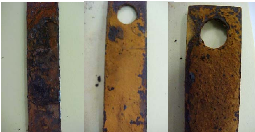
Figura 77 – Remoção natural da camada corroída na superfície do corpo de prova de aço carbono (ASTM 283-GR C)
