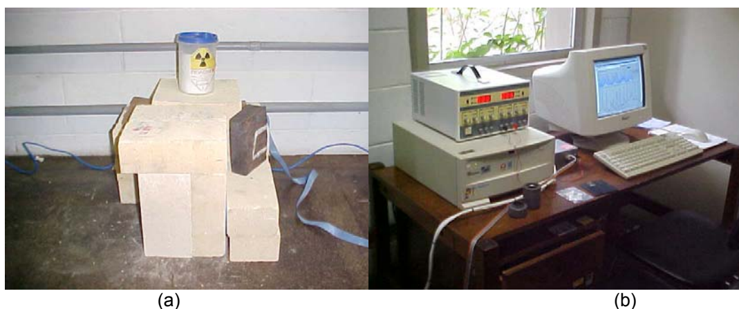
Figura 34 - (a) - Receptáculo de amostras com fonte de ^{57}\text{Co} em matriz de Rh com atividade de 8 mCi. (b) Fonte e analisador Mössbauer do laboratório de espectroscopia Mössbauer da CST
