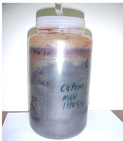
Figura 66 - Condensado de COG – a presença de ferrocianeto é indicada pela forte cor azul
