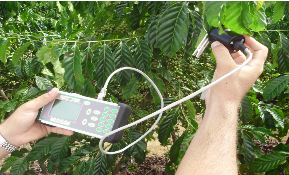
Medição cinética da fluorescência transiente da clorofila a em Coffea canephora .
