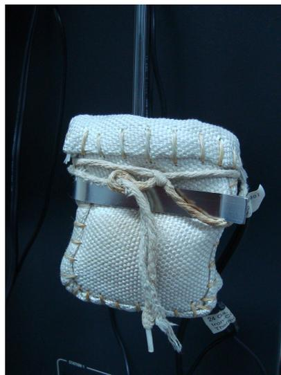
Figura 3.3 – Manta térmica utilizada durante a purga.
