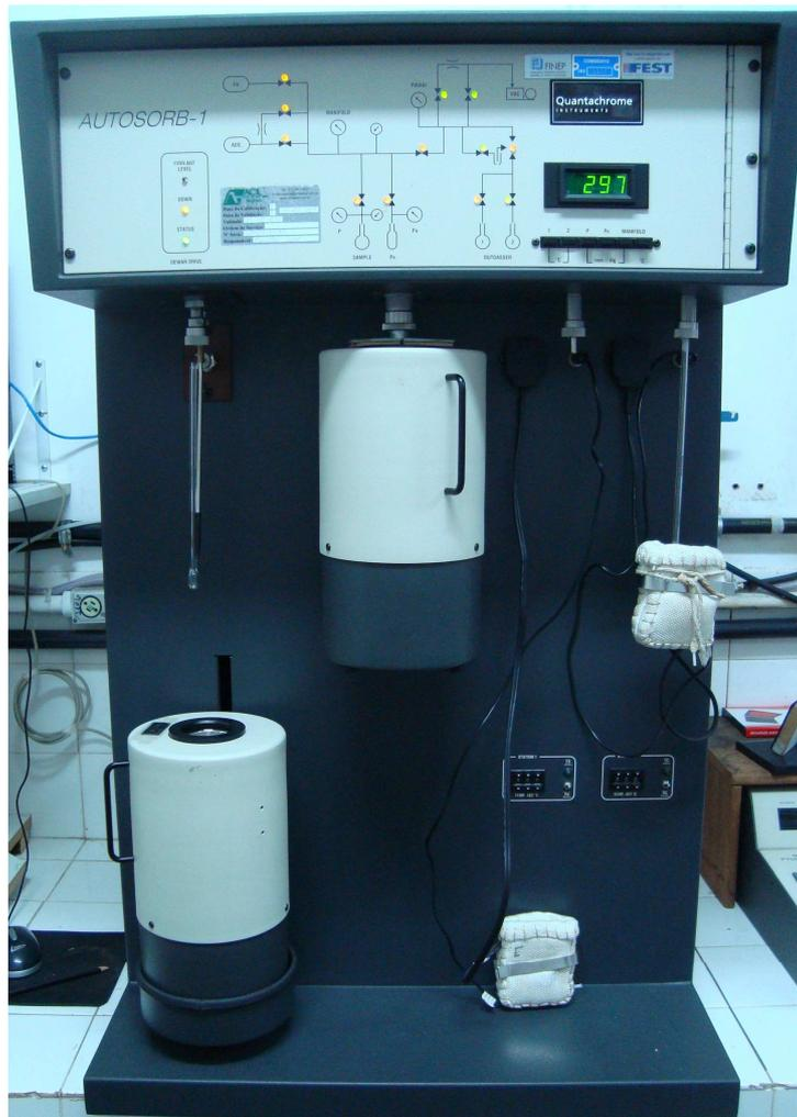
Figura 3.4 – Foto do equipamento Autosorb-1 utilizado para realizar as medidas de área superficial específica.
