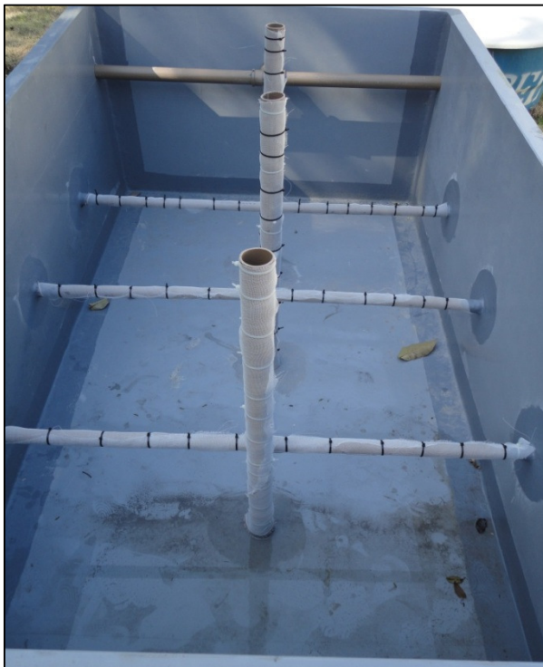
Figura 16. Malhas adicionadas às tubulações.
