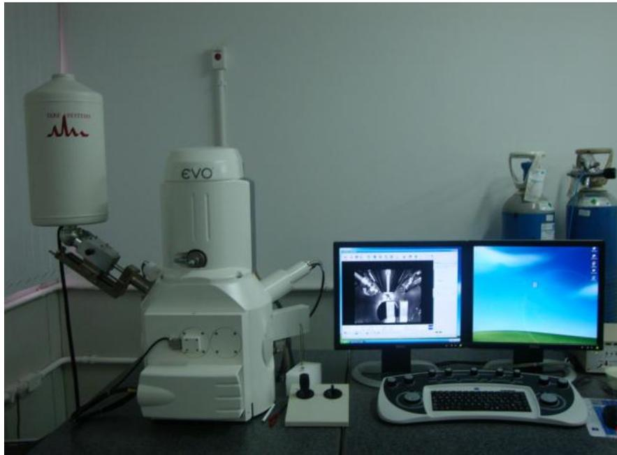
Figura 6.6: Microscópio eletrônico ZEISS EVO 40, do Laboratório de Análise de Superfície de Materiais do Departamento de Engenharia Mecânica, no Centro Tecnológico da Universidade Federal do Espírito Santo.
