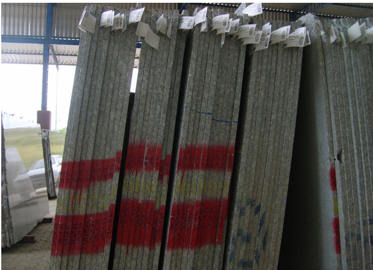
Figura 16: Identificação das chapas por código de barras para controle do estoque.
