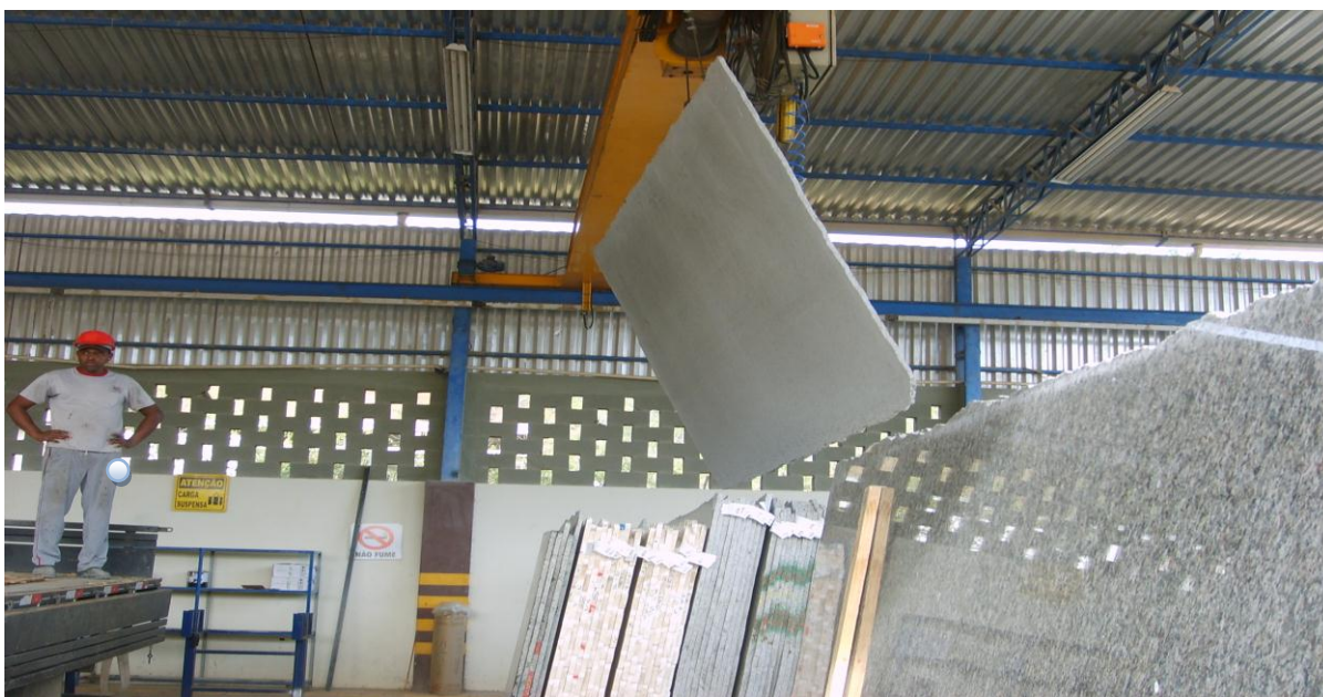
Figura 26: Movimentação de chapas realizado de forma irregular.
