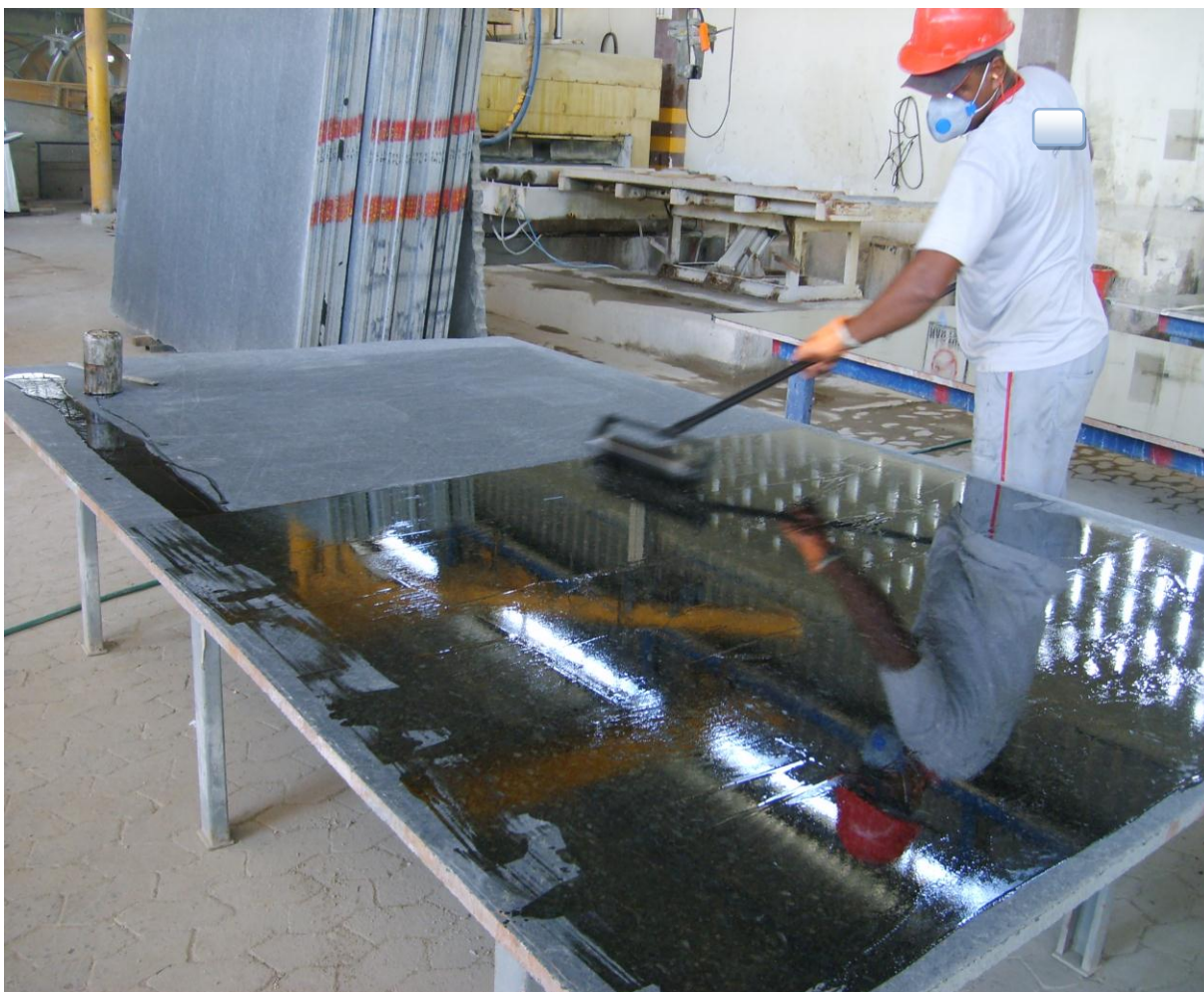
Figura 13: Aplicação da resina com o uso do rolo de tacnew .
