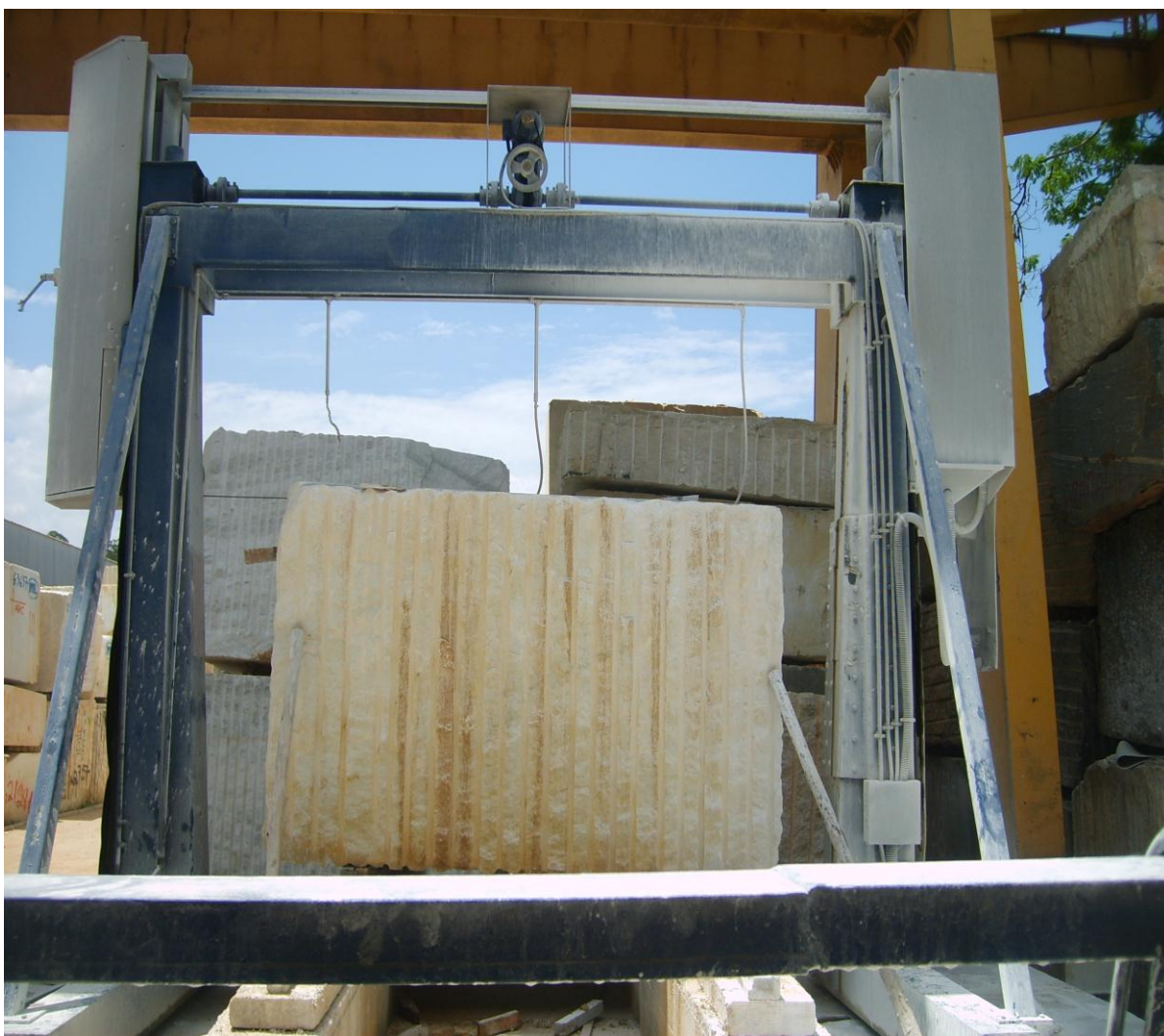
Figura 03: Processo de corte das aparas dos blocos no tear diamantado.
