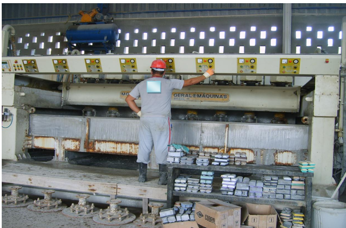
Figura 08: Processo de polimento, painéis de controle para alinhamento dos cabeçotes e pastilhas de abrasivo.
