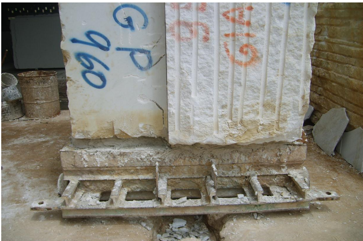
Figura 04: Processo de fixação dos blocos a serem serrados.
