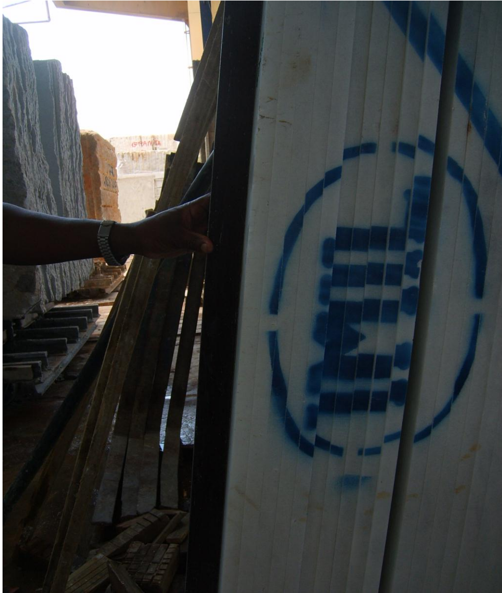
Figura 20: Conferência de nivelamento das chapas serradas.
