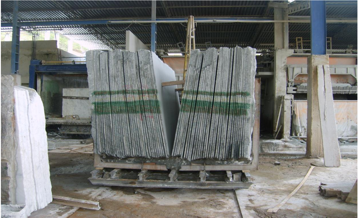
Figura 06: Chapas serradas retiradas dos teares e identificadas.
