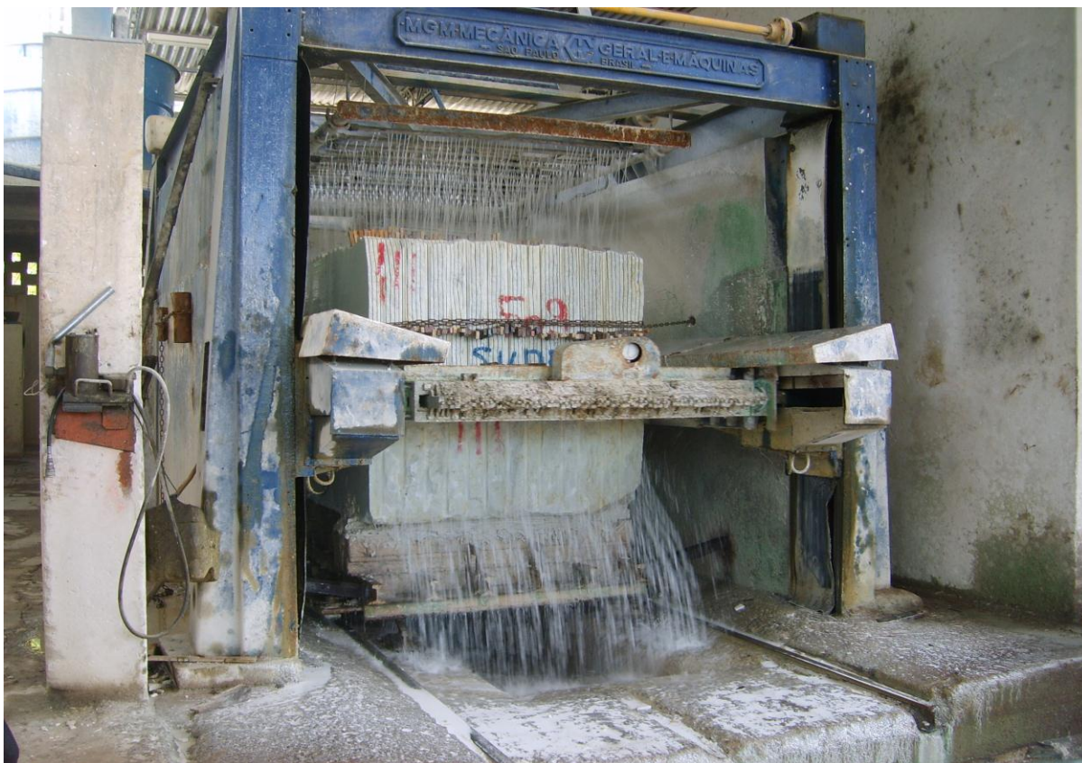
Figura 05: Processo de serragem dos blocos – escoramento das chapas através de cunhas de madeira, para evitar quebra.
