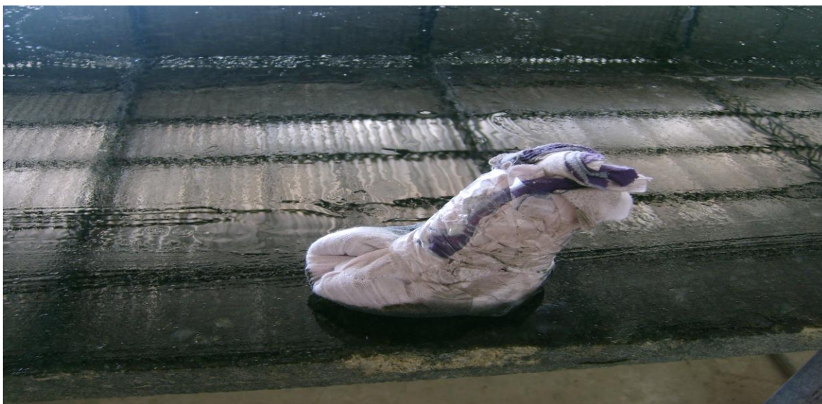
Figura 23: Peteca de trapo utilizada para acabamento do resinamento nas bordas das chapas.
