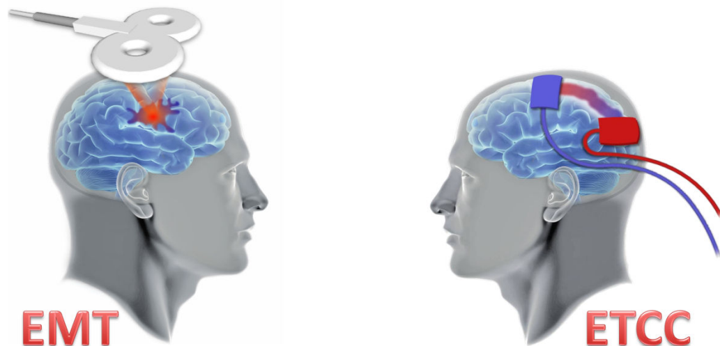
Figura 1 – Modelo esquemático simplificado da administração tradicional das técnicas de Estimulação Magnética Transcraniana (EMT), à esquerda, através de uma bobina em oito, conectada a um sistema capacitor e de Estimulação Transcraniana por Corrente Contínua de Baixa Intensidade (ETCC), à direita, por meio de um par de eletrodos (catodo e anodo), conectados a um estimulador de corrente elétrica.
