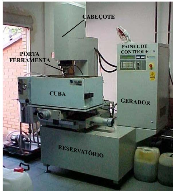
Figura 3.7 - Equipamento EDM por penetração-Engemac 440 NC no Laboratório de Tribologia e Materiais – Uberlândia [ARANTES, 2001].
