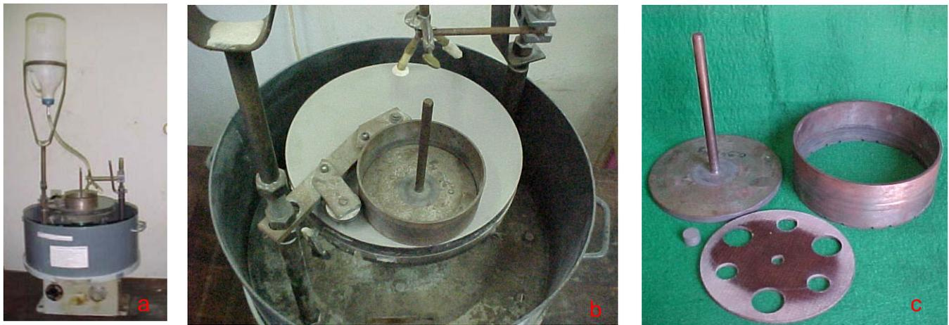
Figura 3.8. a) Vista geral do abrasômetro; b) Vista superior em detalhe; c) Componentes: Dispositivo de aplicação de carga e porta – amostra.
