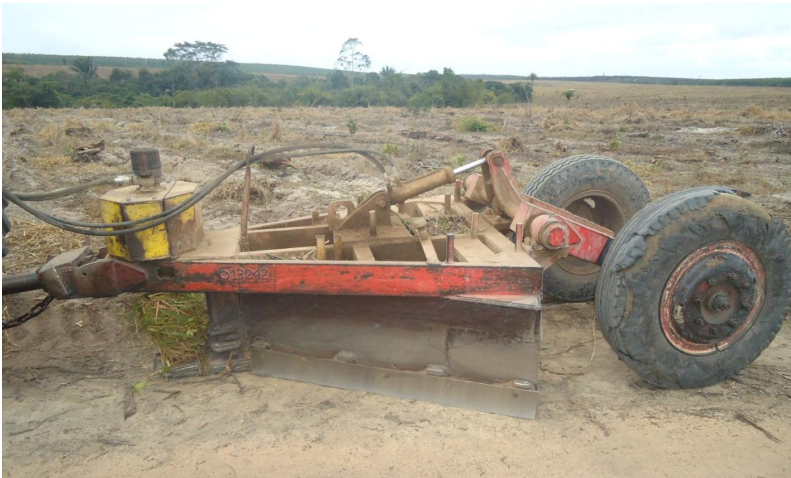
Figura 2. Implemento limpa trilho (estrovenga) utilizado na operação de afastamento de resíduo.
