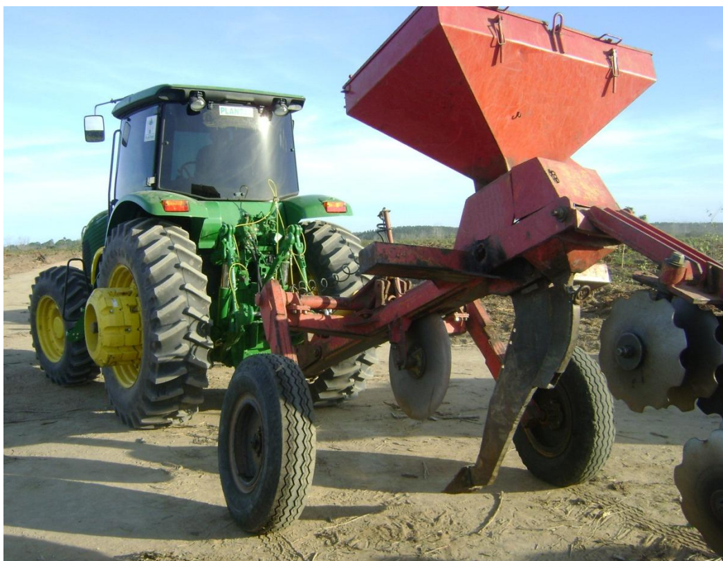
Figura 3. Trator agrícola e subsolador com sistema de adubação utilizado na operação de subsolagem com adubação fosfatada.
