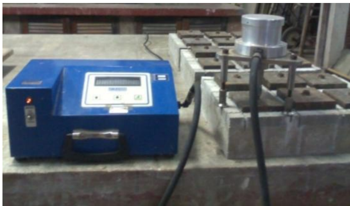
Figura 3.18 – Equipamento utilizado na execução do ensaio de arrancamento.
