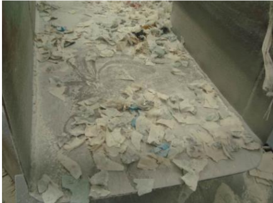
Figura 2.3 – Esteira do moinho onde ocorre a separação do vidro e PVB
