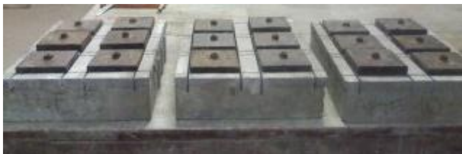
Figura 3.17 – Substrato padrão com a argamassa aplicada e pastilhas metálicas coladas aguardando a execução do ensaio de arrancamento.
