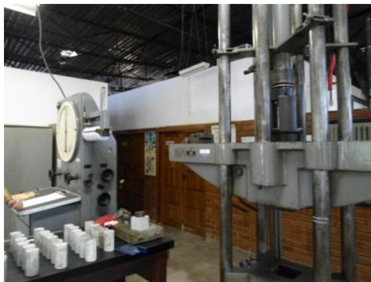
Figura 3.14 – Ensaio para determinação da resistência à compressão axial
