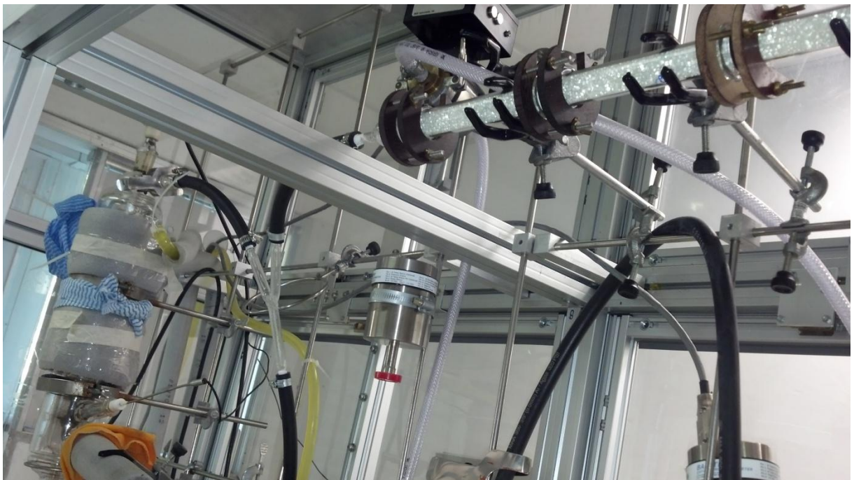
Figura 21. Sistema de captura de ácidos no topo da unidade de destilação atmosférica.
