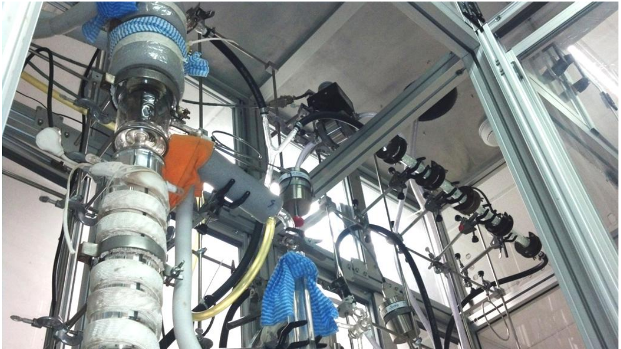
Figura 20. Sistema de destilação atmosférica com sistema de captura de ácidos no topo.
