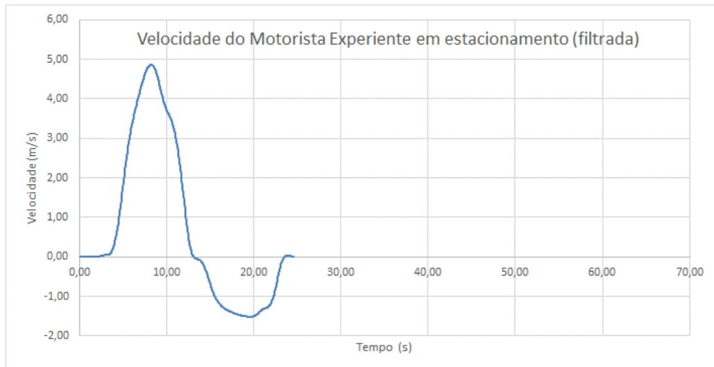
**Figura 30 - Velocidade do motorista experiente com filtragem em função do tempo no teste de estacionamento.**
