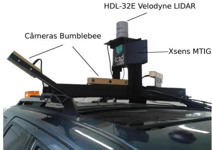
**Figura 19 – Sensores do robô.**
