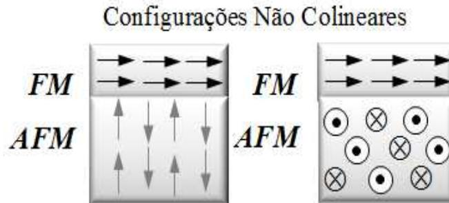
Figura 2.4: Diagrama esquemático de duas configurações de *spins* com acoplamento não-colineares (ângulo de  $90^\circ$ ) em bicamadas FM/AFM [5].
