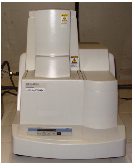
Figura 13- Equipamento DTG-60H Shimadzu, utilizado nos experimentos de termogravimetria (UFU).
