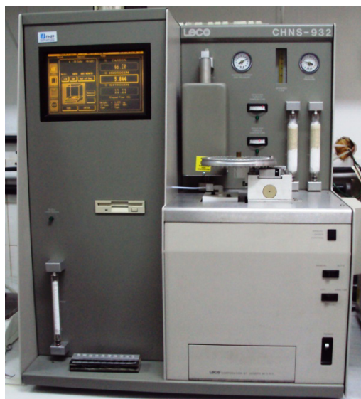
Figura 12- Equipamento utilizado na análise elementar das amostras de embalagem e seus componentes puros - CHNS-932 Leco .
