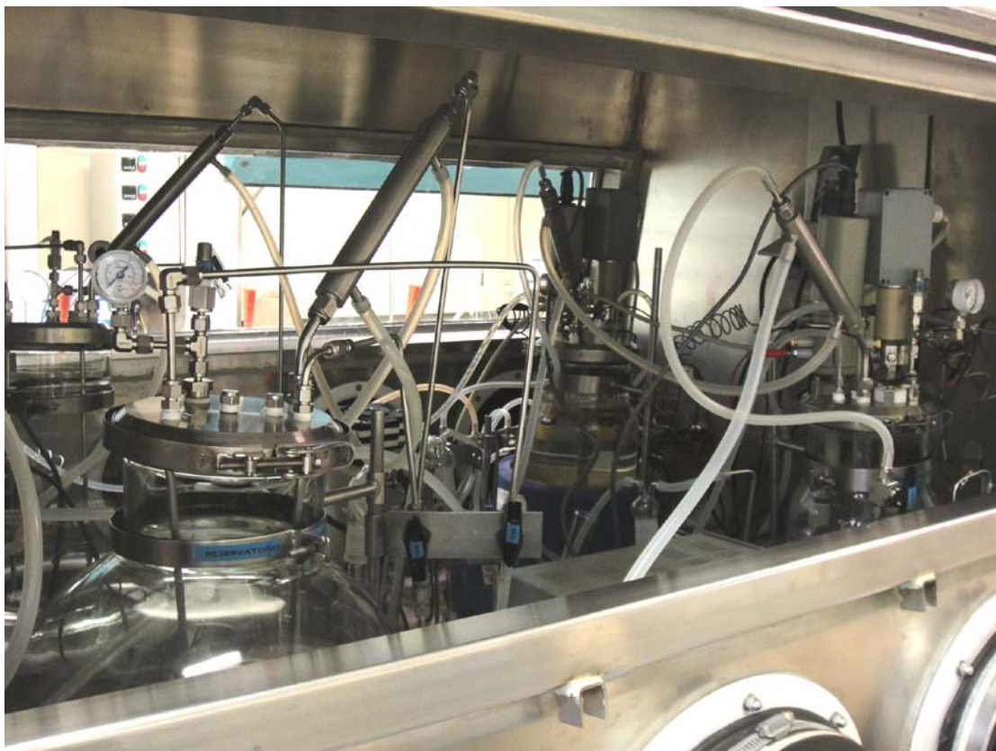
Figura 10 – Gloove Box. Reservatórios e Células de Teste
