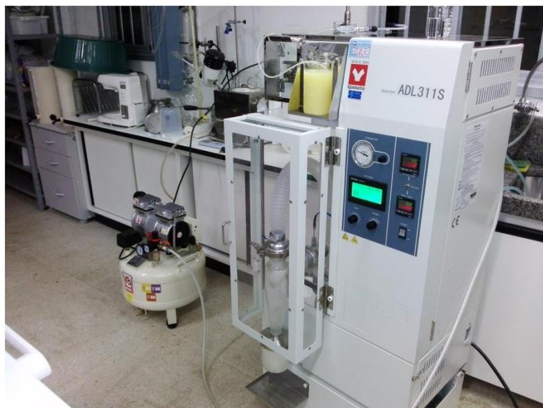
Figura 4 – Conjunto compressor e atomizador (spray-dryer) utilizado no processo de secagem.
