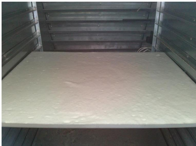
Figura 5 – Espuma resultante do processo de bateção.
