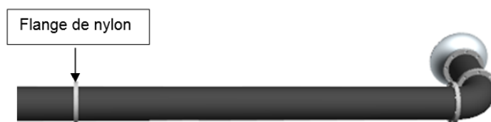
Figura 7. Conexão entre partes constituintes do túnel de vento a partir de flanges tipo macho-fêmea
