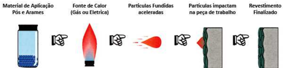
Figura 14 - Esquema do método de deposição por aspersão térmica (HVOF). Fonte: [24]
