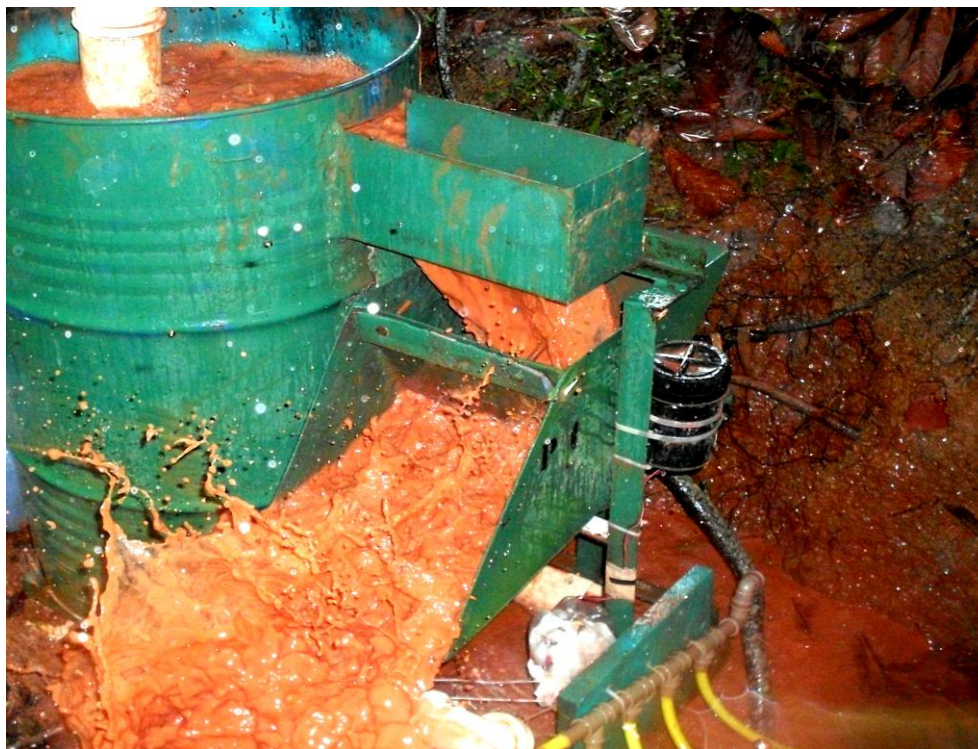
Figura 31 – Medidor de fluxo em funcionamento.
