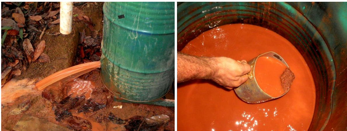
Figura 26 – Coleta de sedimentos grosseiros retidos no tambor.
