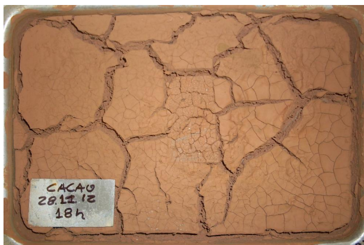
Figura 61 – Sedimentos retidos no tambor após secagem em estufa.
