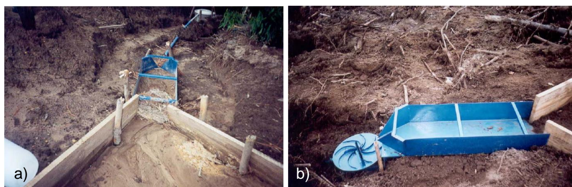
Figura 11 – Amostrador de enxurrada tipo Coshocton. Fonte: a) Corrêa (2005); b) Corrêa e Dedecek (2009)
