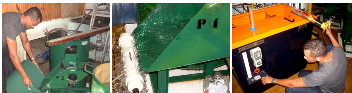
Figura 19 – Calibração dos medidores de fluxo
