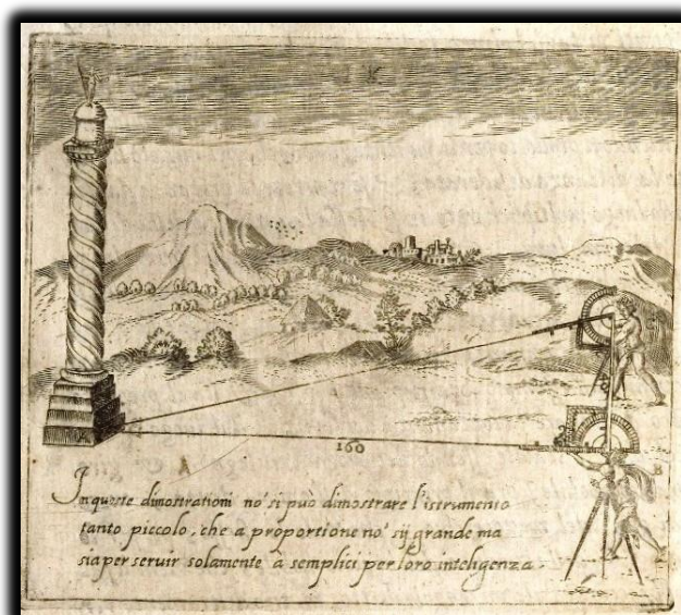
Figura 49: Ilustração que demonstra um modo de usar o esquadro móvel sendo acomodado sobre o tripé
