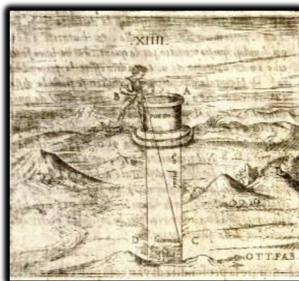
Figura 60 – Proposta XIII 116 : Aprender a profundidade de uma coisa instalada (poço) posta perpendicularmente abaixo num lugar onde se pode ver o fundo Fonte: Fabri (1615, p. 79).
