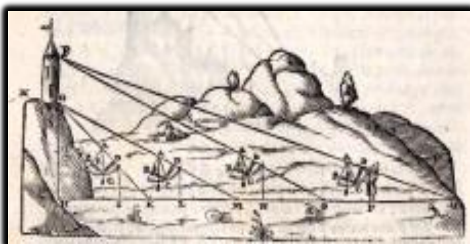
Figura 42 – Ilustração de como usar o quadrante geométrico para medir a altura de um objeto vertical sobre um monte irregular por Oronce Finé Fonte: Fineo (1587, p. 273).
