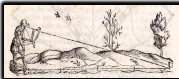
Figura 26 – Ilustração de como usar o quadrante num quarto de círculo Fonte: Fineo (1587, p. 246).
