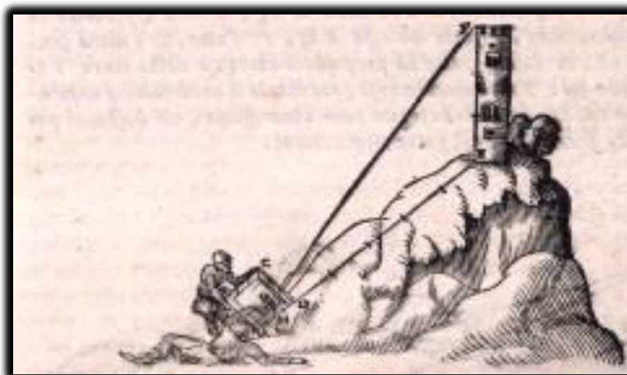
Figura 40 – Ilustração de como usar o quadrante geométrico para medir a altura de um objeto vertical sobre um monte por Oronce Finé Fonte: Fineo (1587, p. 273).
