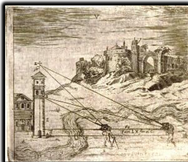
Figura 57 – Proposta V : Medir a altura de uma coisa erguida sobre um plano, ao pé do qual não se pode aproximar Fonte: Fabri (1615, p. 55).
