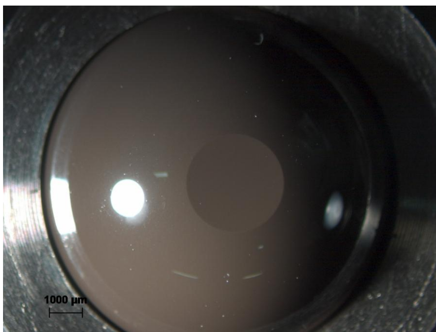
Figura 30 – Foto da superfície de uma esfera de nitreto de silício contendo a superfície plana formada em decorrência de um ensaio tribológico.
