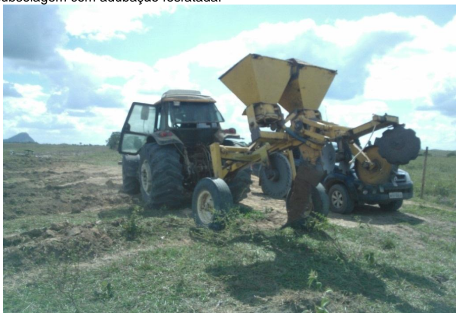
Figura 3 – Trator agrícola e subsolador com sistema de adubação utilizado na operação de subsolagem com adubação fosfatada.
