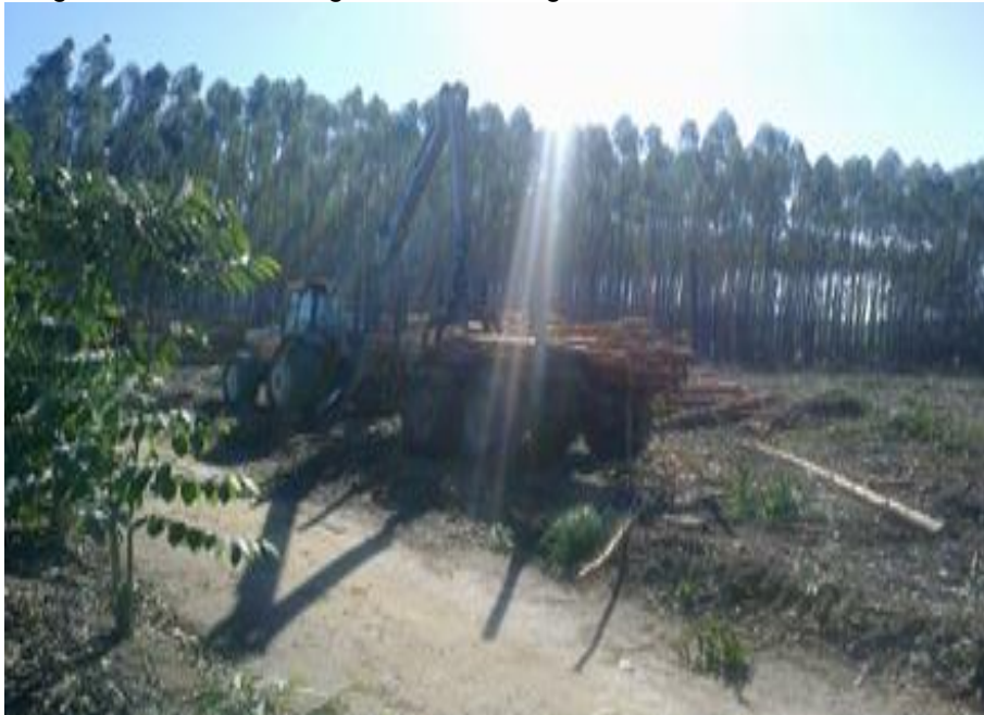
Figura 7 – Carregamento com trator agrícola autocarregável.
