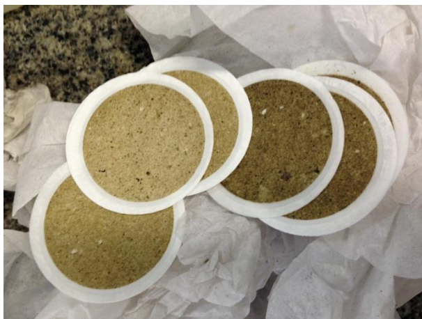
Figura 4.9– Filtrado das amostras de esgoto.
