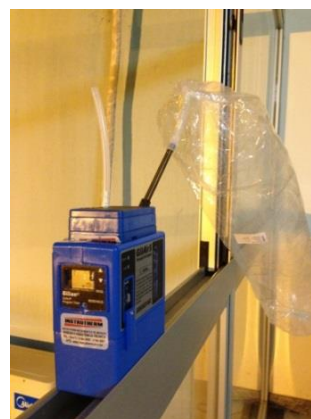
Figura 4.21– Amostra de biogás sendo passada para o cartucho adsorvedor.
