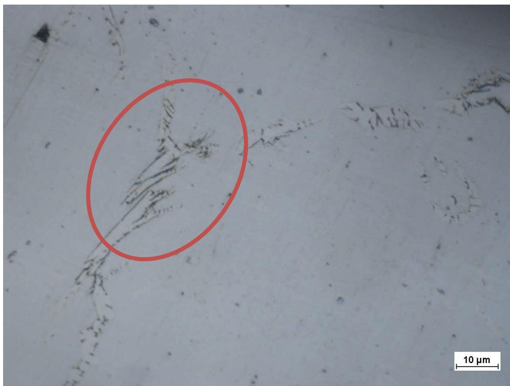
Figura 4-12 Micrografia da amostra A1 com ataque KOH 12% presença de fase sigma na interface austenita-ferrita.
