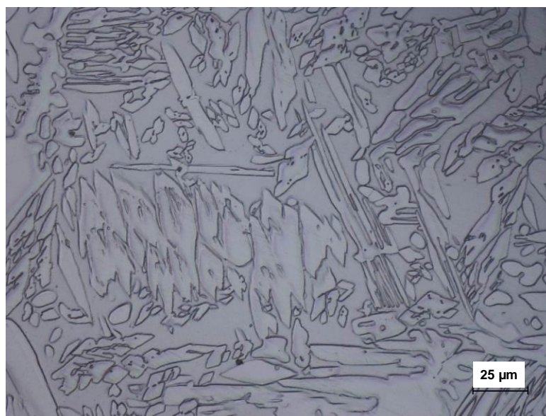
Figura 4-9 - Micrografia da amostra AR2 atacada com oxálico 10% 3V 180s
