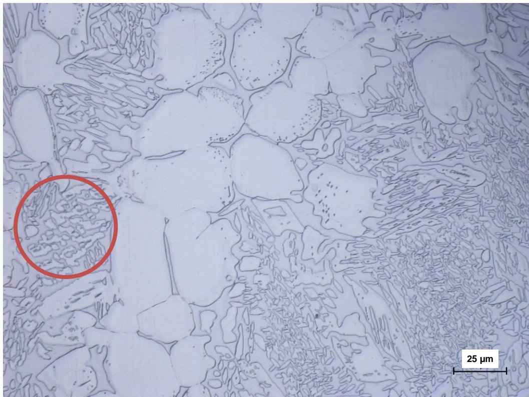
Figura 4-6 - Micrografia da amostra A2 atacada com oxálico 10% 3V 180s
