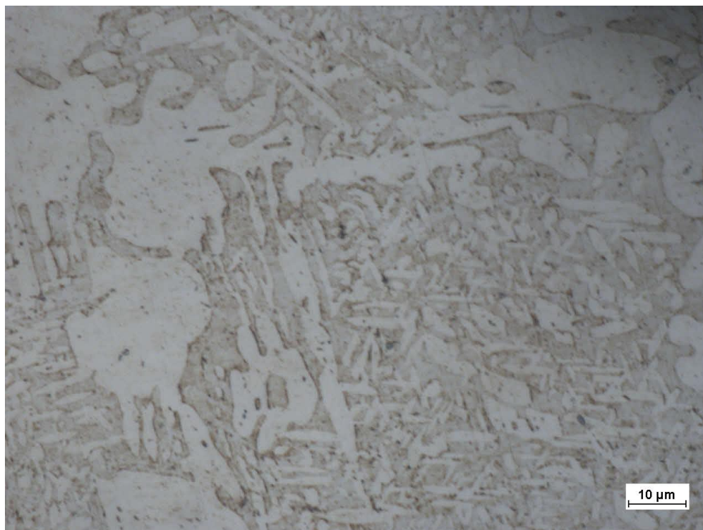
Figura 4-15 Micrografia da amostra A2 com ataque KOH 12% maior presença de fase sigma.
