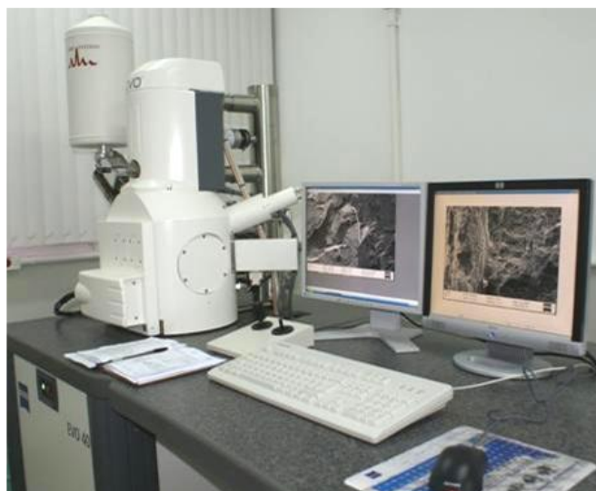
Figura 3-7 - Microscópio Eletrônico de Varredura (MEV) UFES
