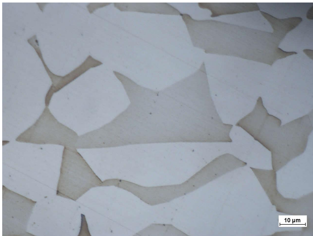
Figura 4-14 Micrografia da amostra FA1 com ataque KOH 12% onde não ocorreu formação de fase sigma.
