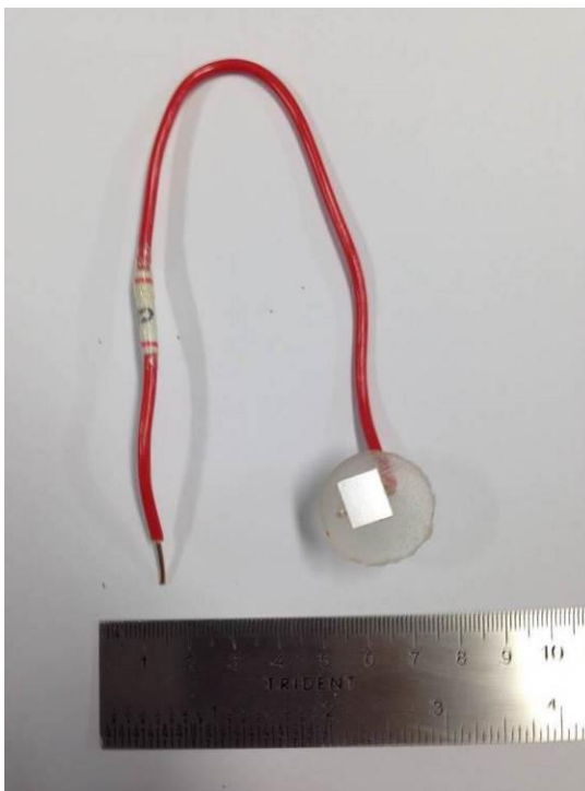
Figura 3-2 - Amostra embutida para ensaios de corrosão
