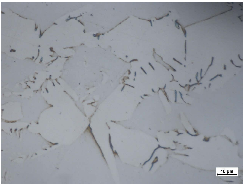
Figura 4-13 Micrografia da amostra O1 com ataque KOH 12% formada na interface austenita-ferrita
