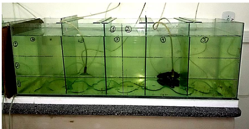
Figura 3 – Um dos aquários experimentais utilizados no teste de aquário vazio com peixes oscar, Astronotus ocellatus (Pisces, Cichlidae). Os números representam as subdivisões dos recintos, lados e altura na coluna de água.
