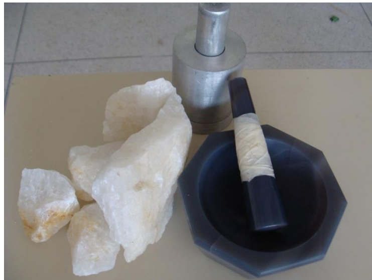
Figura 3.7 - Almofariz de ágata, rochas de quartzo (leitoso) e molde cilíndrico (pastilhador) para compressão.
