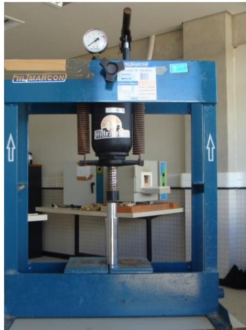
Figura 3.5 - Prensa hidráulica (10 ton) e molde (pastilhador) cilíndrico de aço na base inferior
