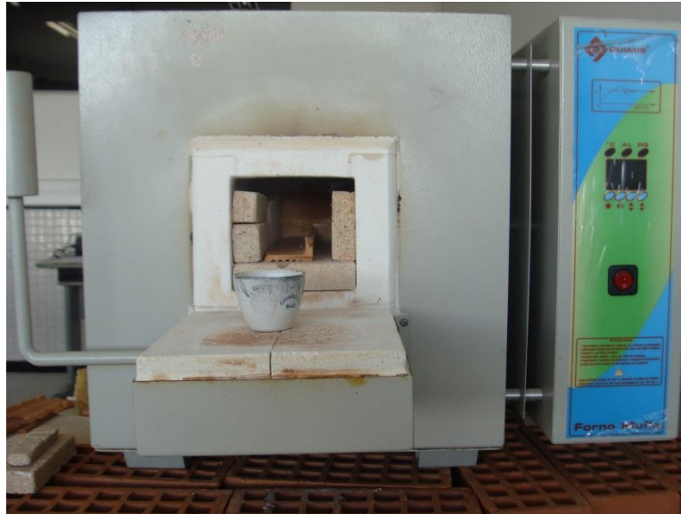
Figura 3.3 - Forno tipo Mufla, Marca Quimis, com valor máximo de temperatura de 1100°C.
