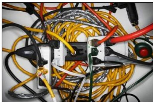
**Figura A.10:** Muitos aparelhos eletrônicos ligados em uma única tomada
