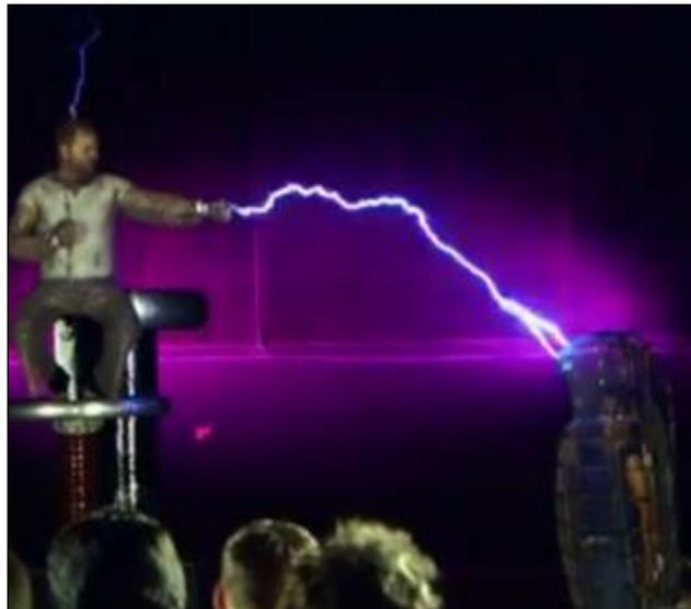
Figura A.2: Arco voltaico direcionado à Gaiola de Faraday
