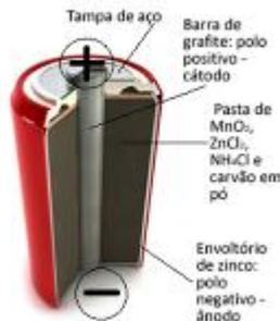
Figura 01: Interior de uma pilha elétrica
