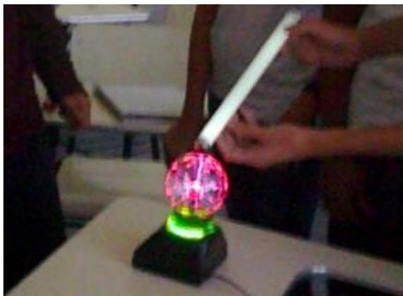
**Figura A.13:** Acendimento da lâmpada fluorescente com o globo de plasma
