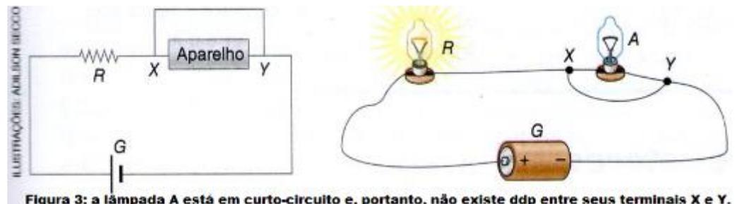
Figura 3: a lâmpada A está em curto-circuito e, portanto, não existe ddp entre seus terminais X e Y.
