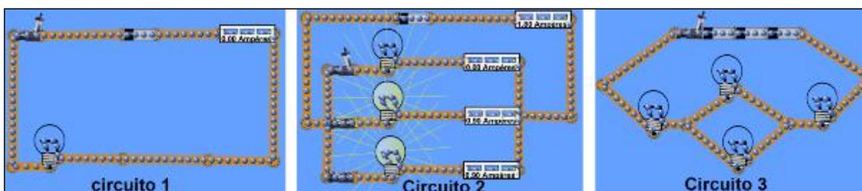
**Figura A.9:** Circuito 1, Circuito 2 e Circuito 3 usados respectivamente para demonstrar associação em série, em paralelo e misto de resistores em circuitos elétricos
