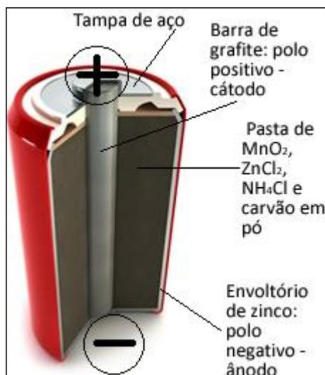
**Figura A.1:** Interior de uma pilha elétrica
