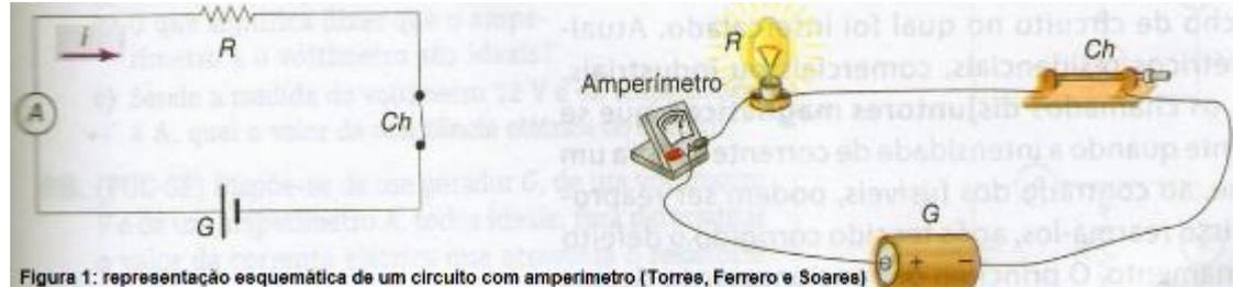
Figura 1: representação esquemática de um circuito com amperímetro (Torres, Ferrero e Soares)
