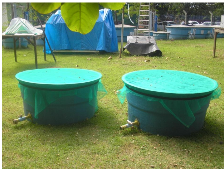
Figura I.1 Reservatórios contendo efluente de UASB+biofiltro+ decantador da ETE/UFES-ES para crescimento natural de microalgas e posterior isolamento.
