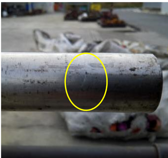
Figura 96 - Haste polida deformada devido aperto excessivo imposto pelo grampo.
