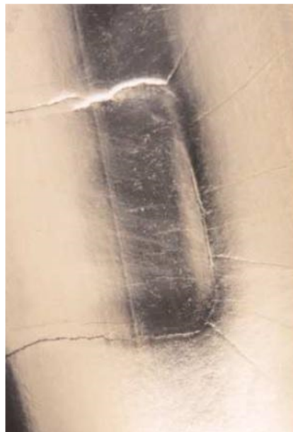
Figura 22 – Trincas na superfície de hastes polidas com spray metal .
