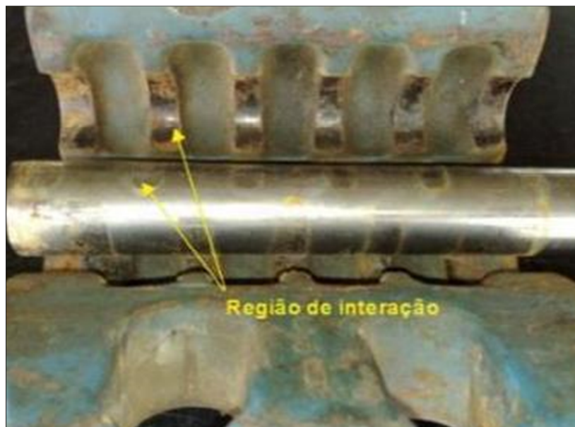
Figura 48 – Região de interação entre a haste polida e o grampo. Fonte: Adaptado de Soares (2010, p.51).
