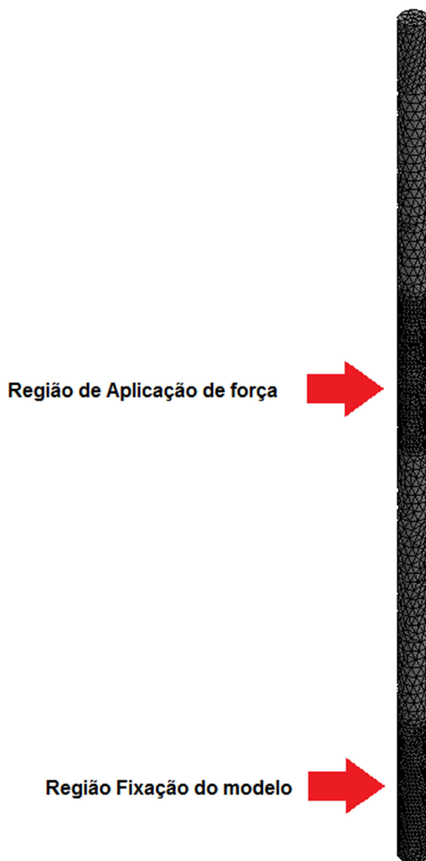
Figura 60 – Discretização do modelo de fixação da haste polida com grampo.
