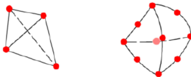
Figura 34 – Elemento linear sólido e elemento parabólico sólido. Fonte: Akin (2009, p.25).
