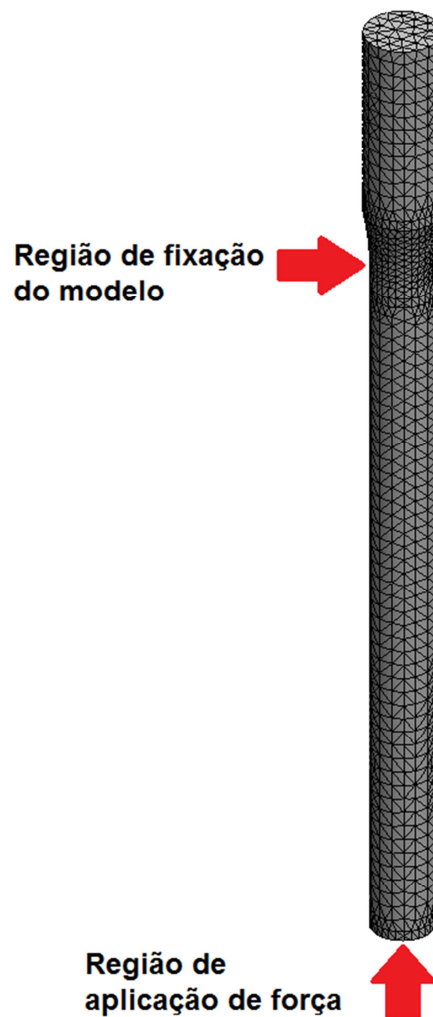
Figura 73 – Discretização da haste polida modificada.
