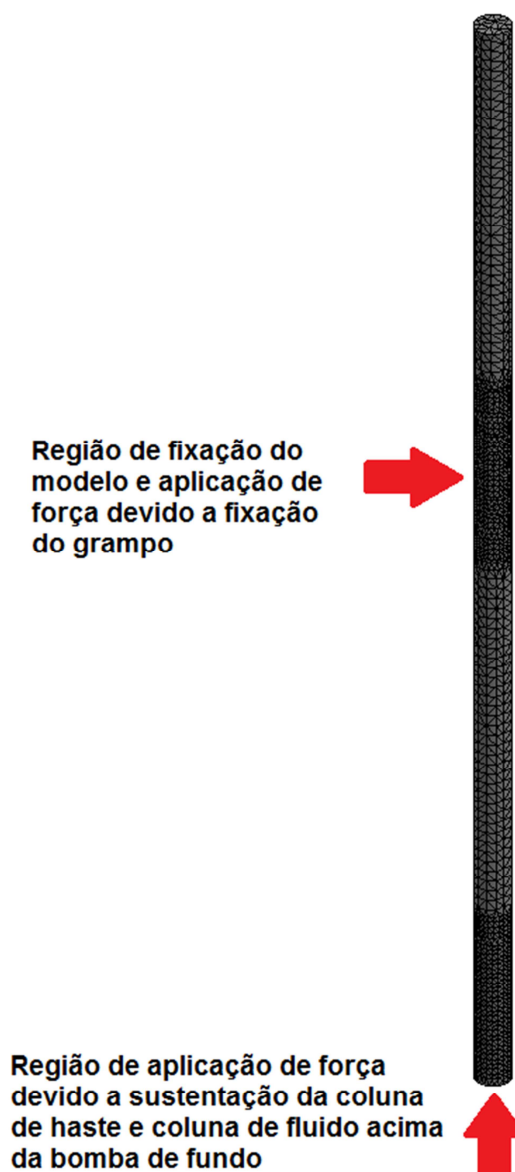
Figura 65 – Discretização do modelo de fixação da haste polida com grampo para análise de fadiga.
