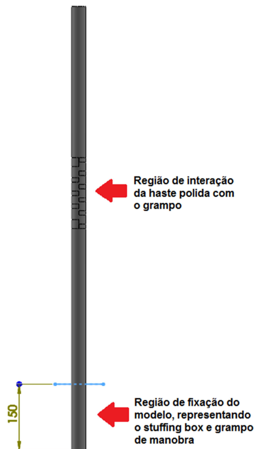
Figura 51 – Detalhes da geometria representativa da interação entre a haste polida e grampo.
