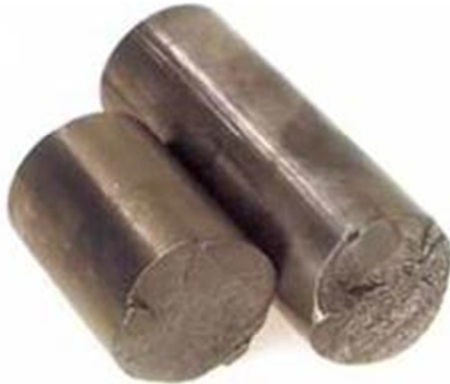
Figura 13 – Exemplo de falha de haste polida com spray metal . Fonte: Hendricks (2001, p.8).
