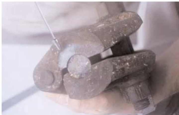
Figura 21 – Fratura visualizada em campo. Fonte: Adaptado de Angelo (1995, p.36).
