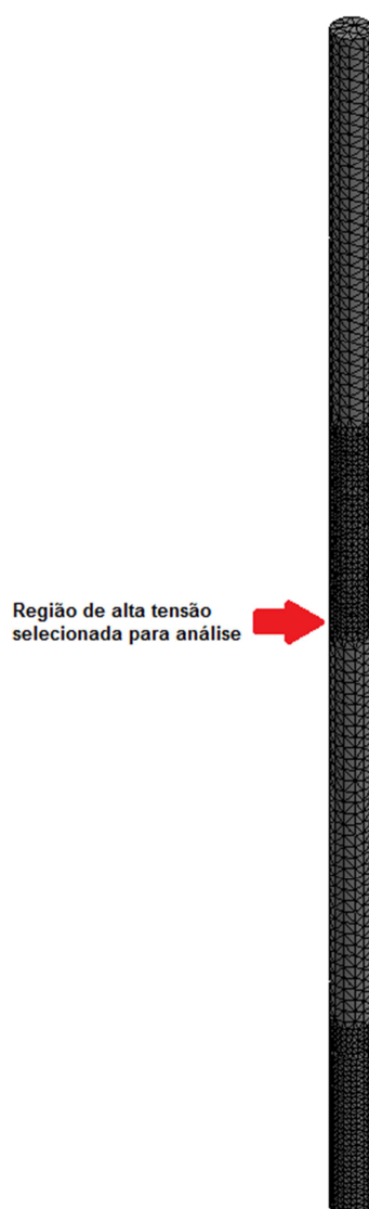
Figura 66 – Região selecionada para análise de convergência do modelo de fixação da haste polida com grampo para análise de fadiga.
