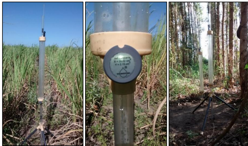
Figura 03. Avaliação de condutividade hidráulica do solo com a utilização do Permeâmetro de Guelph.
