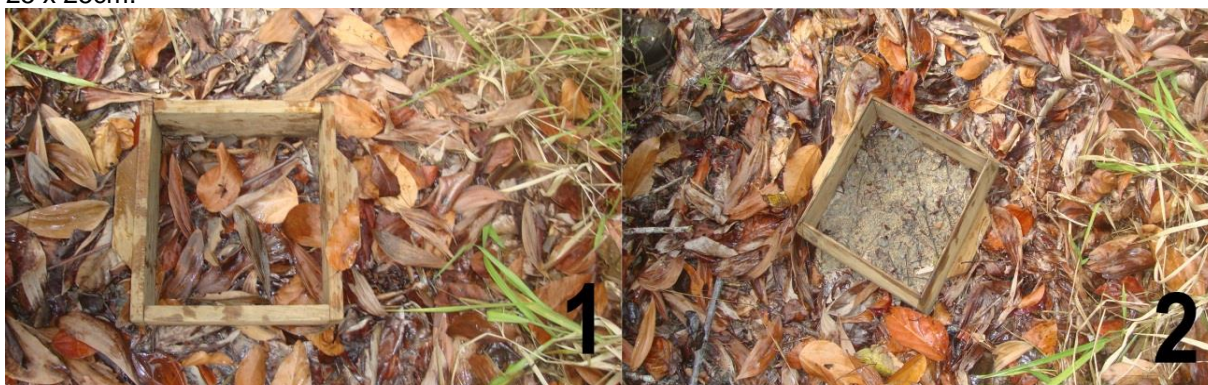
Figura 8 - Processo de coleta das amostras de serapilheira acumulada com auxílio de um gabarito de 25 x 25cm.
