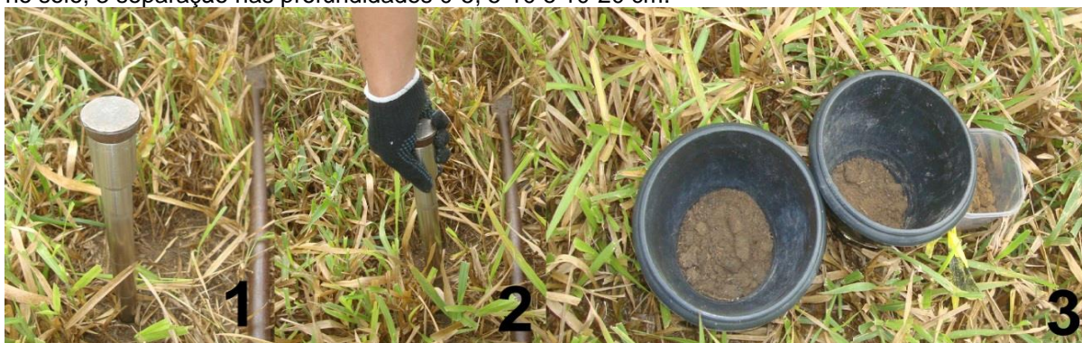
Figura 7 - Processo de amostragem do solo em que: 1 Fixação da sonda no solo; 2 retirada da sonda do solo; 3 separação nas profundidades 0-5, 5-10 e 10-20 cm.
