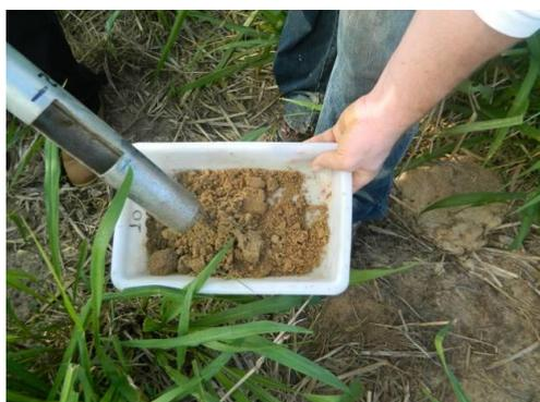
**Figura 5** - Amostragem do solo realizada com auxílio de uma sonda de 1,30 m comprimento e 50 mm diâmetro, realizada na propriedade Santa Marta, município de Jerônimo Monteiro – ES.
