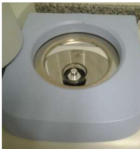
Figura 5: Célula de transfectância com petróleo utilizada para leitura na região do NIR.
