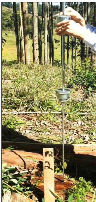
Figura 7 – Avaliação da profundidade de penetração utilizando o equipamento penetrômetro de impacto
