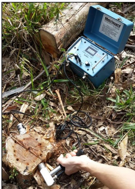
Figura 8 – Avaliação da deterioração dos tocos utilizando o equipamento Stress wave timer.
