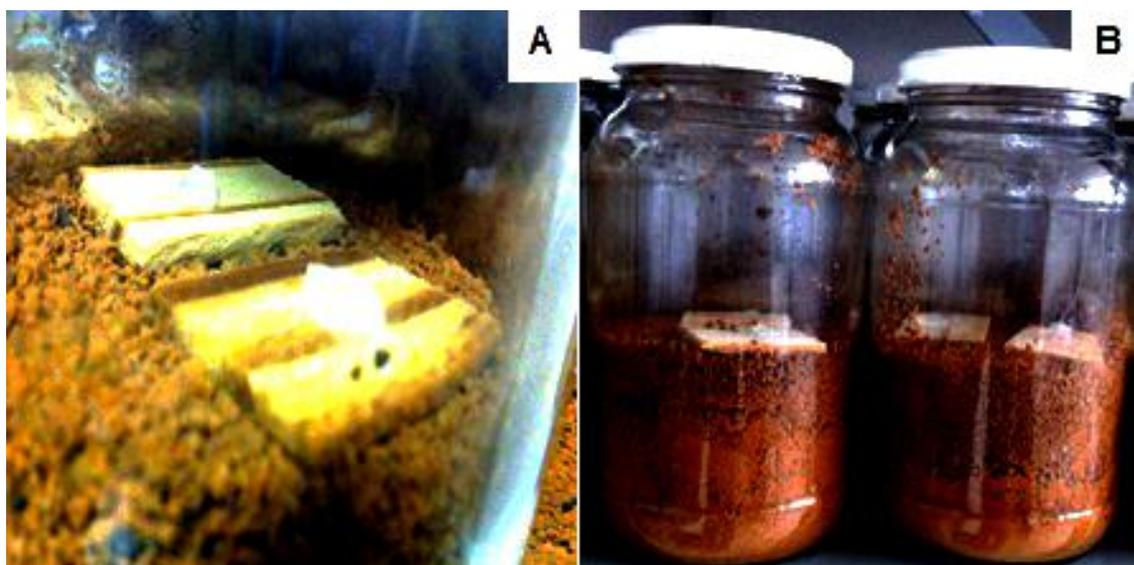
A resistência à deterioração pelos fungos xilófagos de cada corpo de prova foi mensurada em termos de perda de massa, de acordo com a ASTM D 2017 (2005) e avaliada qualitativamente de acordo com classes de resistência como descrito na Tabela 2.
