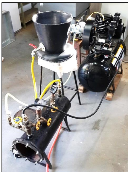
Figura 7 – Autoclave-piloto onde as amostras serão tratadas com extrativos.
