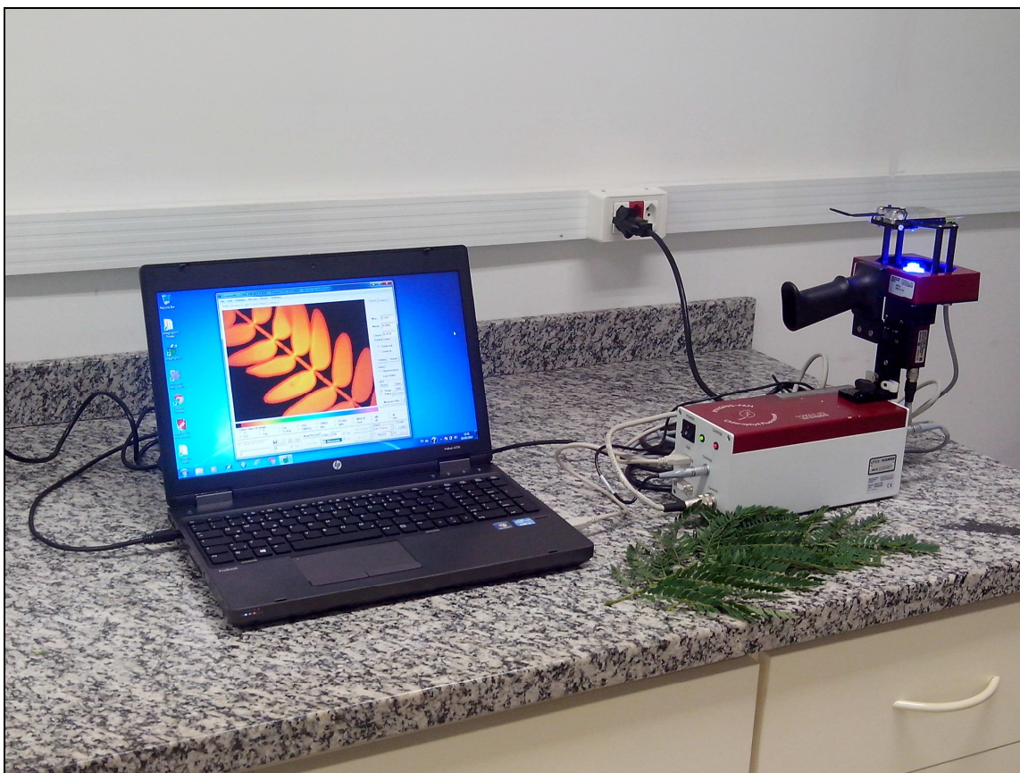
Figura 2 Fluorômetro modulado Imaging-PAM (Heinz Walz, Effeltrich,Germany) versão Standard, acoplado a notebook.
