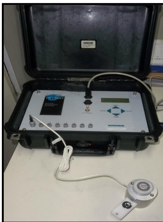
Figura 1: Psicrômetro (câmara C-52, Wescor) conectado ao microvoltímetro (Psy-PRO, Wescor, Logan, USA) utilizado para determinar o \Psi_s . Fonte: Arquivo pessoal.
