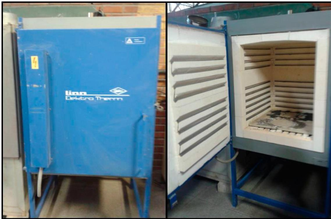
**Figura 3.2:** Mufla com temperatura máxima de até 1400°C.
