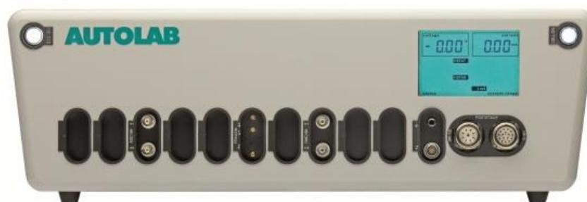
**Figura 3.11:** Potenciostato AUTOLAB PGSTAT 302N.
