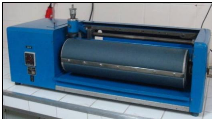
Figura 15: Máquina de ensaio ASTM D 5963.
