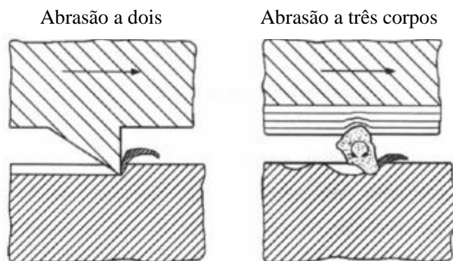
Figura 2: Exemplo de desgaste a dois e a três corpos (ZUM GAHR, 1987).
