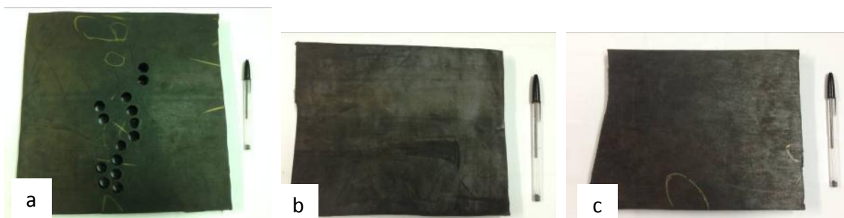
Figura 28: Vista de cima de pedaços de correias transportadoras onde foram extraídos a) Rub1, b) Rub2, c) Rub3.
