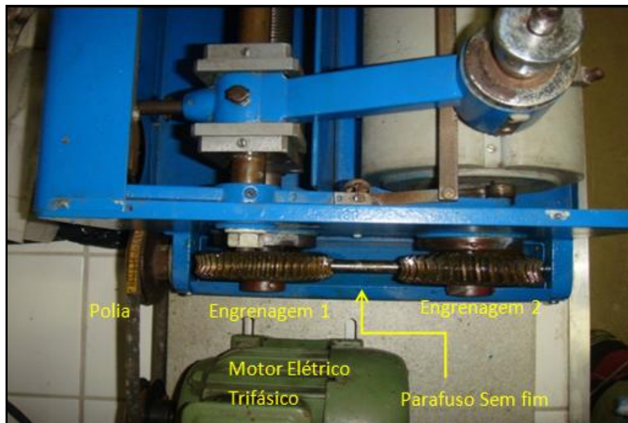
Figura 39: Mecanismo da máquina de ensaio abrasivo.
