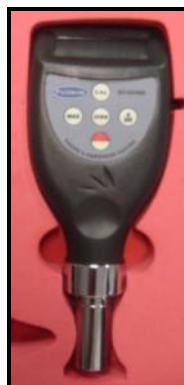
Figura 31: Durômetro portátil de dureza Shore A.
