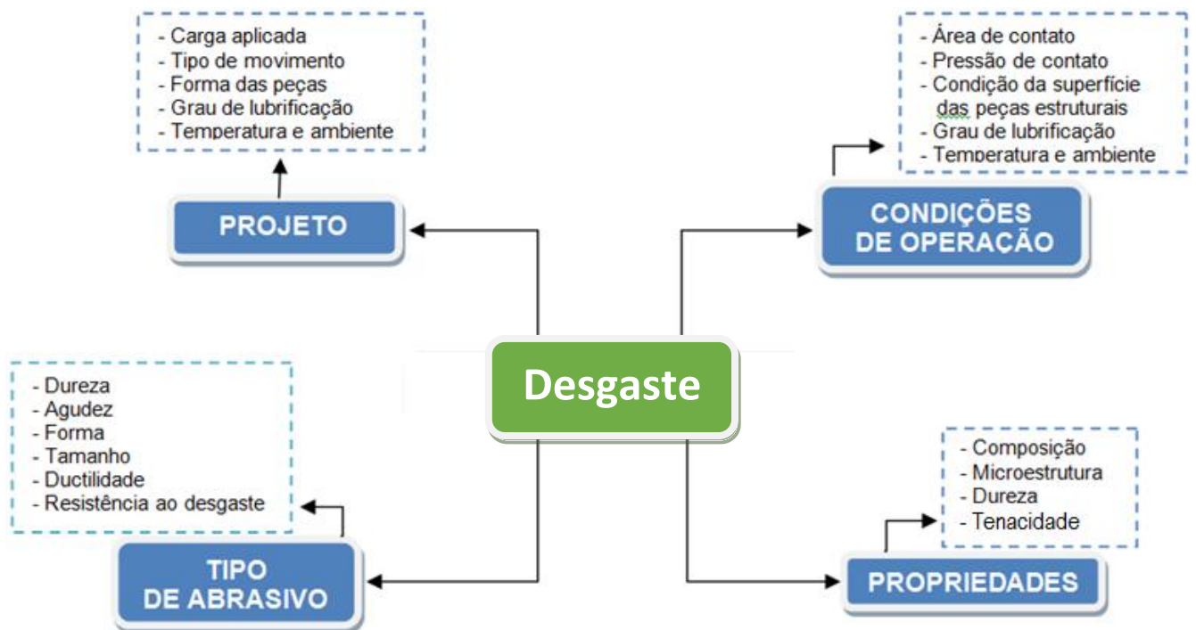
Figura 4: Parâmetros do desgaste abrasivo (adaptado de ZUM GAHR, 1987).
