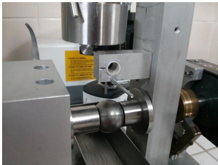
Figura 21. Montagem da esfera entre os semi-eixos.
